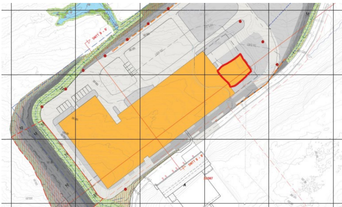
Figur 3 Rød firkant viser plassering av reservetransformator i nordøstre ende av stasjonsarealet. Kilde: Statnetts søknad
