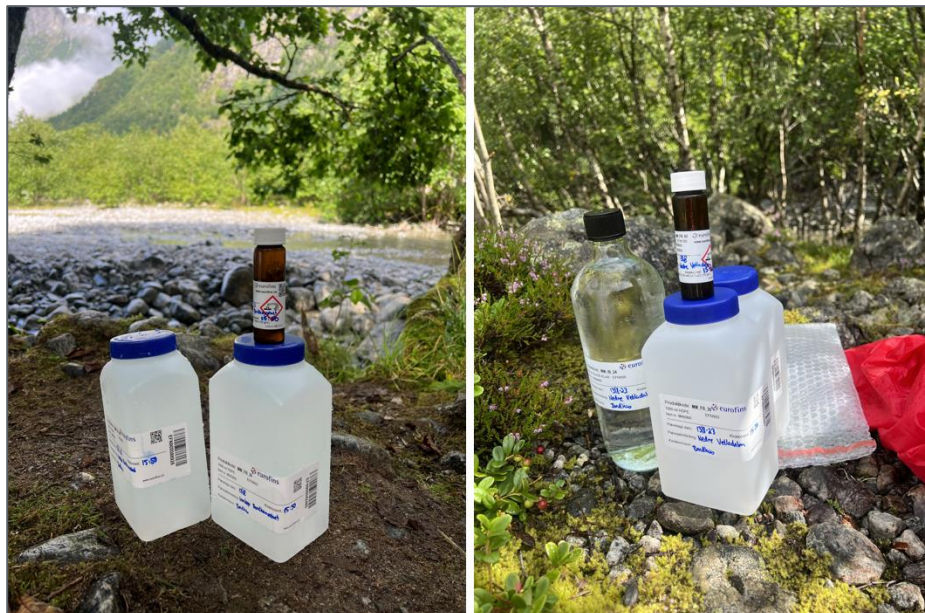
Figur 2-3: Prøvetakingsmateriale fra lokalitetene Pyttelva, Innløp, Utløp og Inntak Vassverk er vist til venstre. Prøvetakingsflasker fra lokalitetene i Øvre og Nedre Vetladalen er vist til høyre. På disse to lokalitetene er det inkludert ei glasflaske for å analysere for organiske miljøgifter. (Foto: Norconsult Norge AS).
