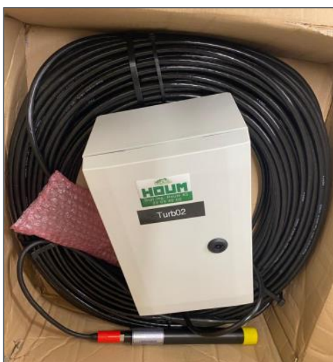
Figur 2-6: Dataloggar levert av Houm, installert i november 2023 (pågåande målingar per april 2024). (Foto: Norconsult Norge AS).
