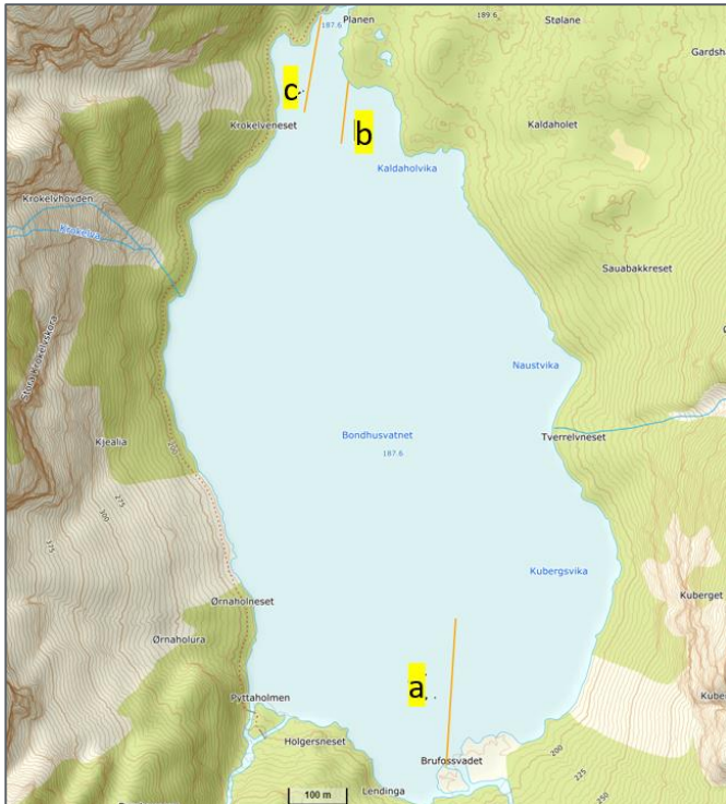
Figur 1-2: Posisjonar for georadarmålingar hausten 2023. Georadarprofil er markert med gule striper a, b og c. Nord er opp på kartet. Kart henta frå Norgeskart.no.
