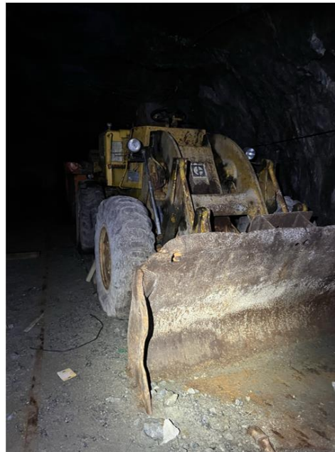
Figur 1-7: Gjenverande lokomotivvogn og hjullastar inne i tunnelsystemet ved «Vinduet» som fram til 1980-talet vart nytta i arbeidet med å tømme sedimentkammeret for massar (foto: Norconsult Norge AS, 11. august T. Lutro).
