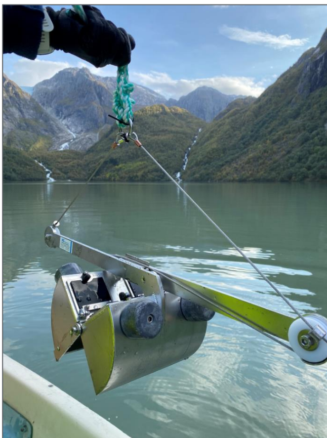
Figur 2-8. Van Veen grabb (250 cm 2 ) brukt til å prøveta sediment i Bondhusvatnet. (Foto: Norconsult Norge AS).
