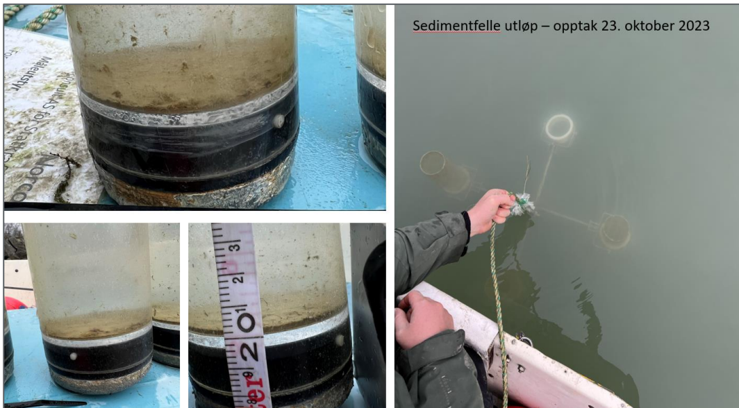
Figur 4-13: Sedimentfelle ved utløp teke opp 23. oktober 2023. Tre av fire kolbar var intakte, den siste hadde velta og falle av stativet. (Foto: Norconsult Norge AS).
