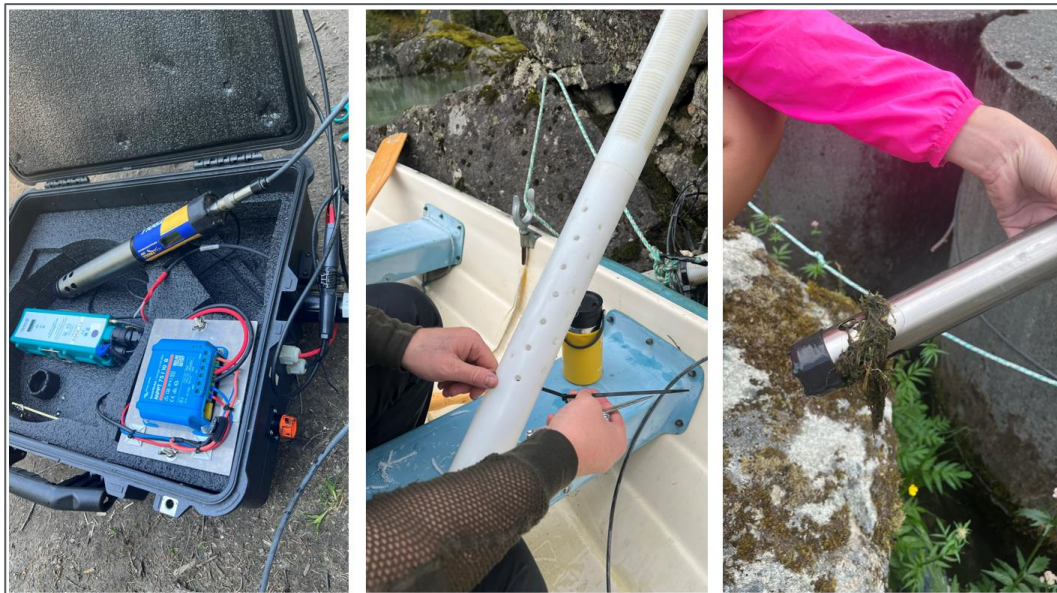
Figur 2-5: Til venstre: AquaTroll med loggeunit (grøn boks) og straumkjelde i blå boks kopla mot eksternt solcellebatteri. I midten: Perforert beskyttelsesrør som turbiditetsmålarane hang inni på stasjon L4-utløp og L5-elv. Til høgre: Utan beskyttelsesrør samla det seg lett organisk materiale som mose og gras på sensoren som forstyrra sensoren og gav forhøga turbiditetsverdiar. (Foto: Norconsult Norge AS).
