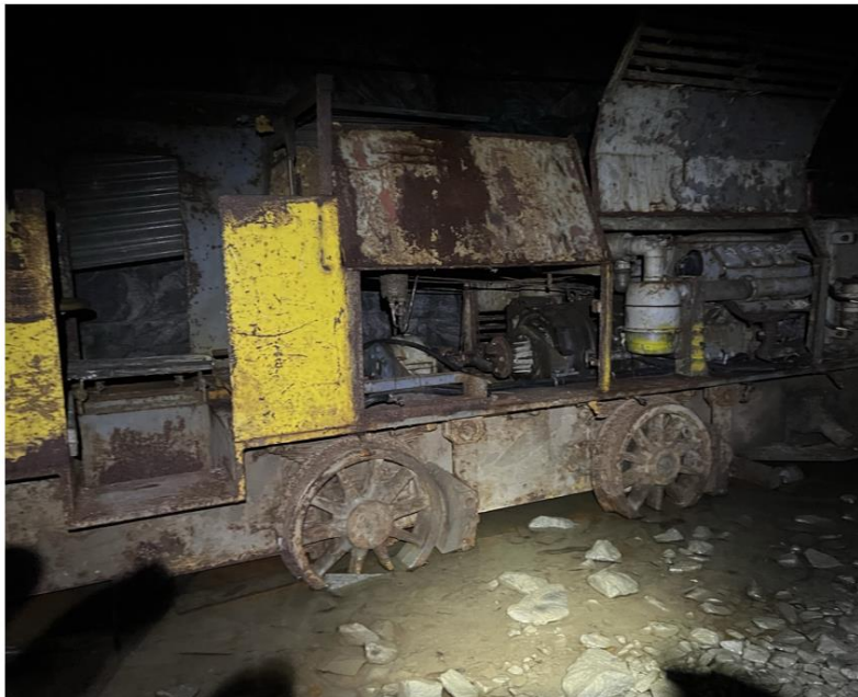
Figur 1-7: Gjenverande lokomotivvogn og hjullastar inne i tunnelsystemet ved «Vinduet» som fram til 1980-talet vart nytta i arbeidet med å tømme sedimentkammeret for massar (foto: Norconsult Norge AS, 11. august T. Lutro).
