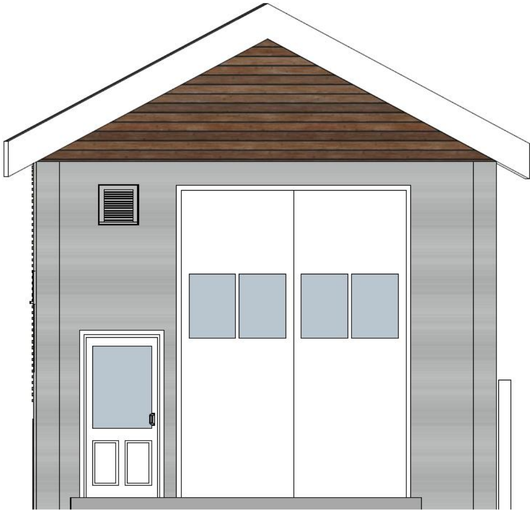
Figur 23 - fasadesnitt av gavl sett fra vei. Dette blir det synlige i terrenget etter ferdig tilbakefylling
