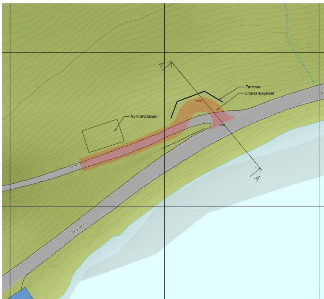
Figur 26 - Utklipp fra geoteknisk rapport angående avkjørsel
