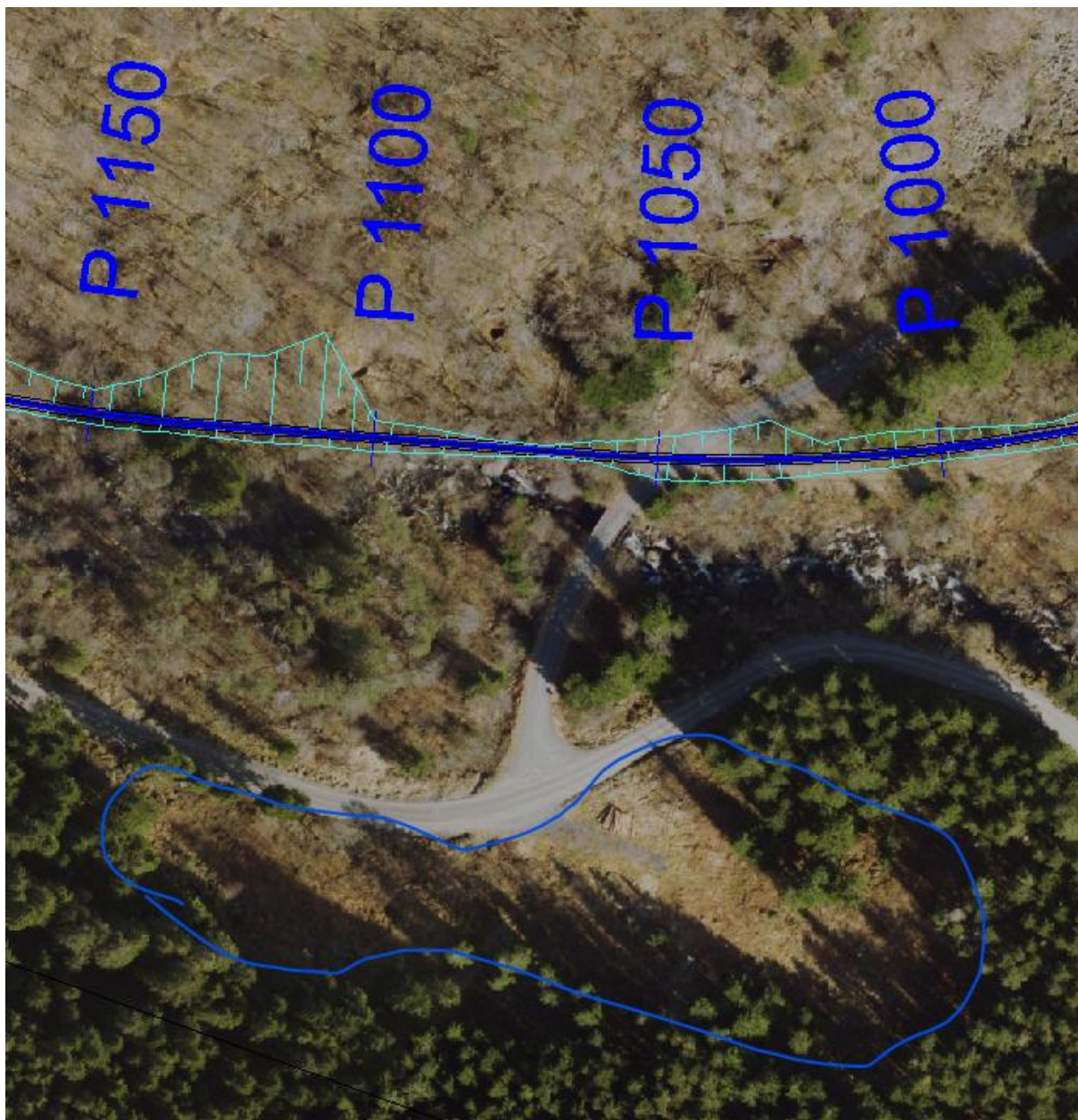
Figur 29 - Området innenfor blå strek benyttes som rørlager. Det gir kort transport inn og ut av rørtrase over Fivelandsveien. Se arealbruksplan.
