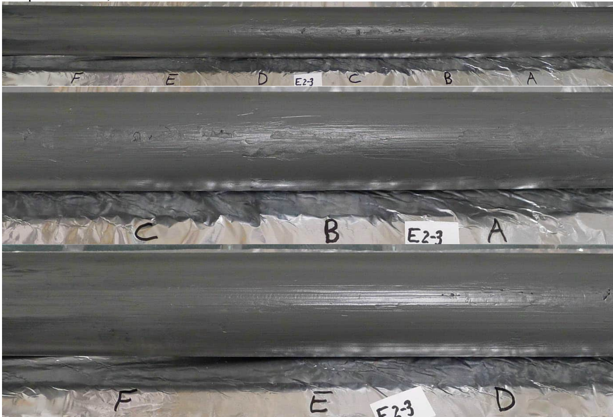
Pr. 3, 54 mm prøve, dybde 6,2-7,0 m: Fin prøve. Leire, kvikk.
