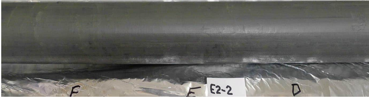
Pr. 3, 54 mm prøve, dybde 6,2-7,0 m: Fin prøve. Leire, kvikk.
