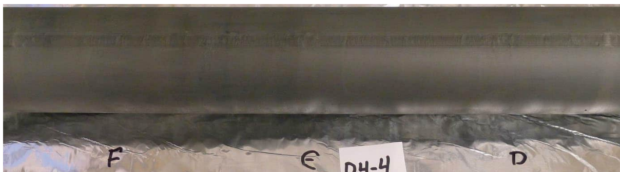
Pr. 5, 54 mm prøve, dybde 6,2-7,0 m: Fast fin prøve, noen svarte striper.
