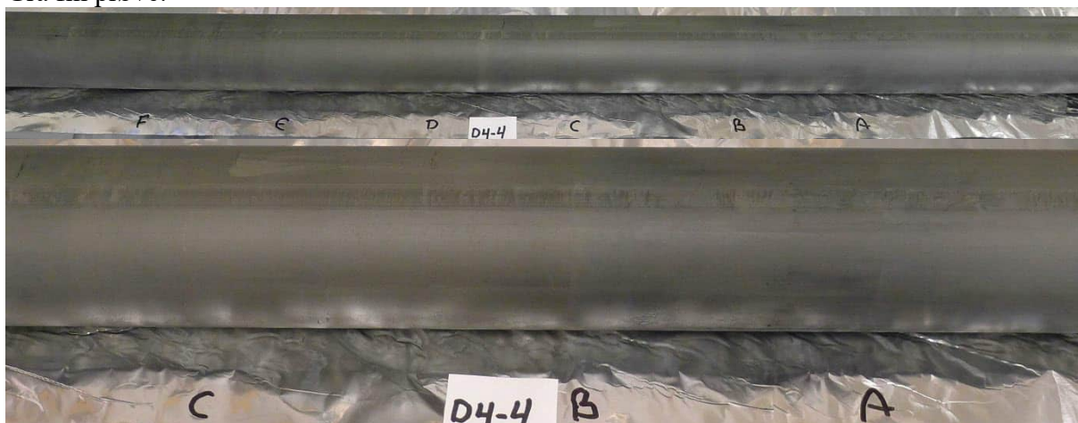
Pr. 4, 54 mm prøve, dybde 5,2-6,0 m: Grå fin prøve.
