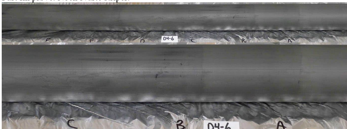
Pr. 6, 54 mm prøve, dybde 7,2-8,0 m: Fast fin prøve. Noen svarte striper.
