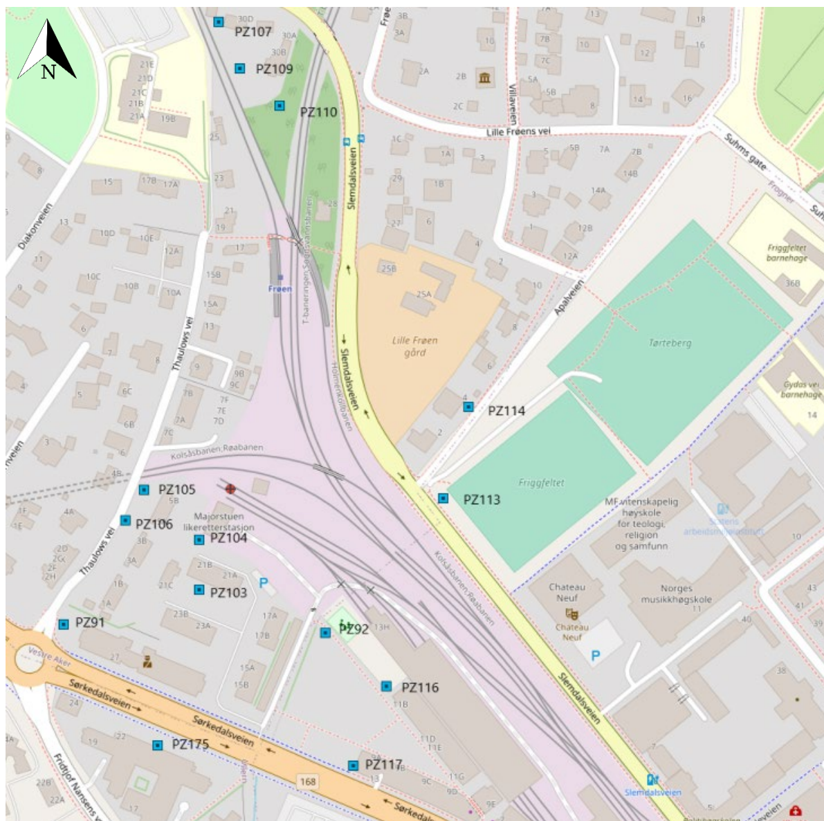
Figur 8-6: Oversikt over piezometre i området rundt Frognerbekken.
