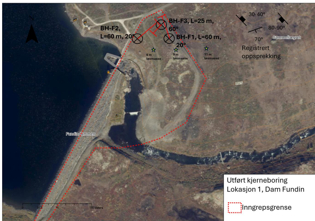
Figur 2: Plassering borehull ved alternativ 1 dam Fundin [2].
