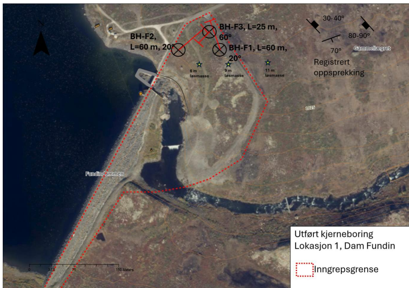
Figur 2-1: Plassering borehull ved alternativ 1 dam Fundin [5].
