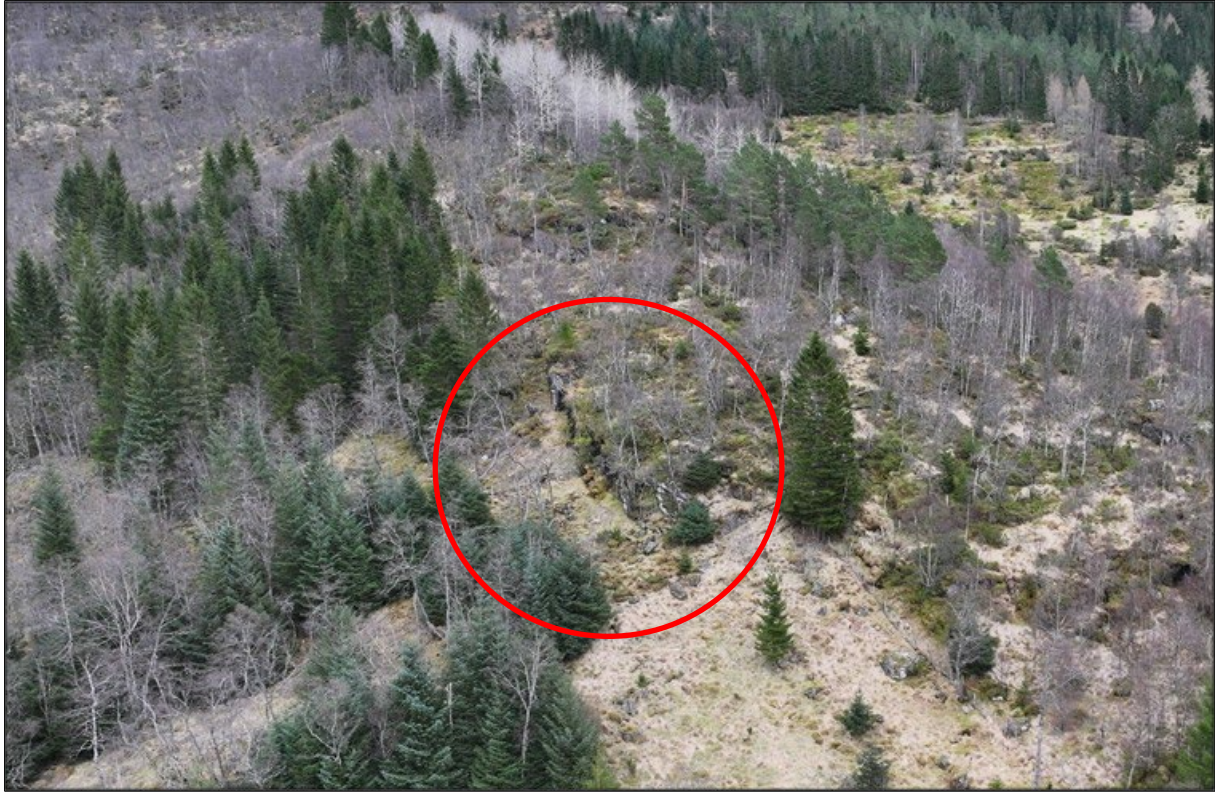
Figur 12: Fjellskrent langs den nordlege delen av Storerabben. Skrenten er om lag 3 – 5 meter høg og vender mot nord. Nedanfor skrenten er det eit avgrensa område med steinsprangmateriale (markert med raud markering). Terrenget nedanfor fjellskrenten er slakt, hovudsakleg under 20°. Infopunkt 2.
