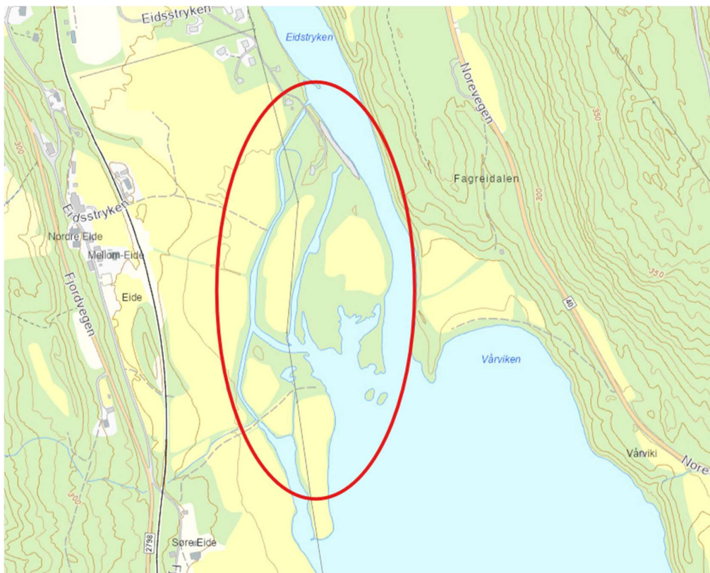
Figur 7-2. Arealer med flomslette som trolig kan tilbakeføres ved gjenåpning av naturlige flomkanaler og fjerning av stein langs elva.
