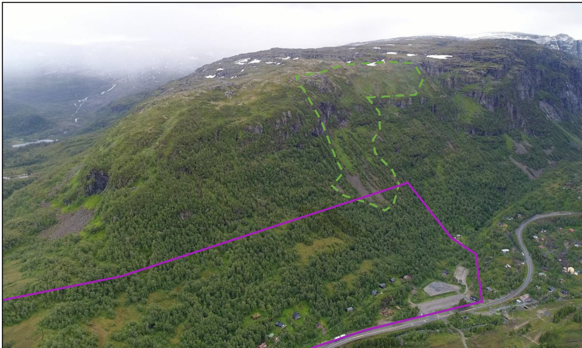
Figur 3: Oversiktsbilde av fjellsiden ovenfor det vurderte området (lilla markering). Dalsida er for det meste dekket av velutviklet skog. De deler av dalsida som kan fungere som utløsningsområder for skred og har begrenset eller ingen skog, er omtrentlig markert med grønnstiplet polygon. Innenfor deler av dette området er det også steinsprangur. Steinsprangura strekker seg videre et stykke nedover i skogen utenfor grønnmerkingen. Bildet er tatt mot øst fra drone.
