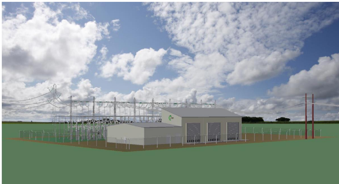
Figur 4.2. Prinsippskisse av utendørs, luftisolert (AIS) transformatorstasjon.
