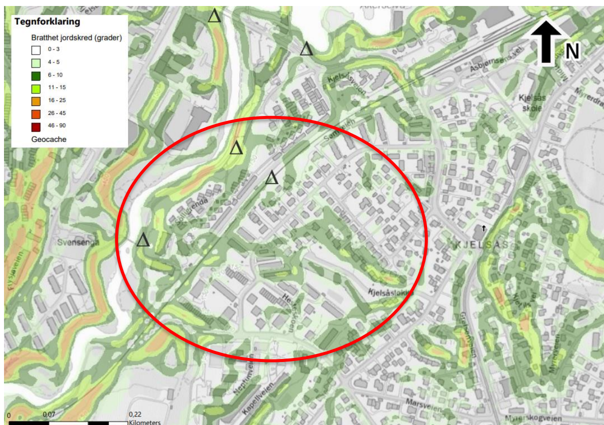
Figur 6-3 Oversiktskart som indikerer terrenghelning, berg i dagen er markert med svart trekant [atlas.nve.no]. Prosjektområdet er markert med rød sirkel.
