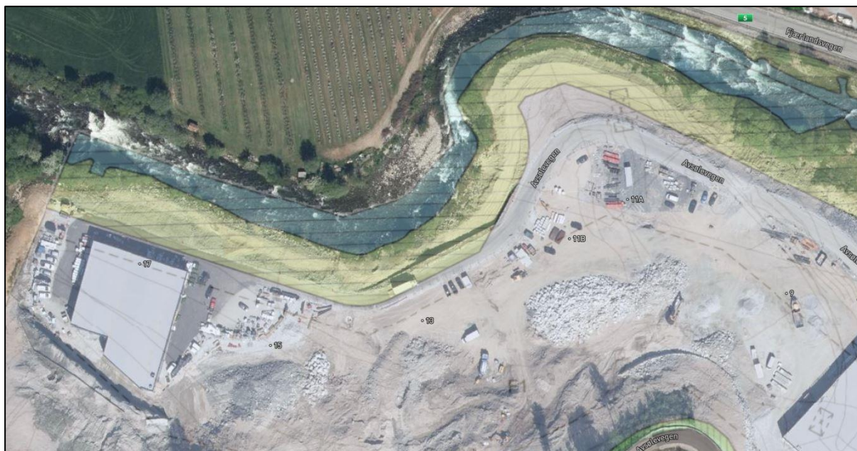
Figur 26 Utsnitt fra Sogndal kommunes planregister. Bildet viser at muren mot elva og deler av en vei er etablert utenfor formålsgrensen (Forretning) i reguleringsplanen Nedrehagen – Kvåle bru. Kilde: kommunekart.no
