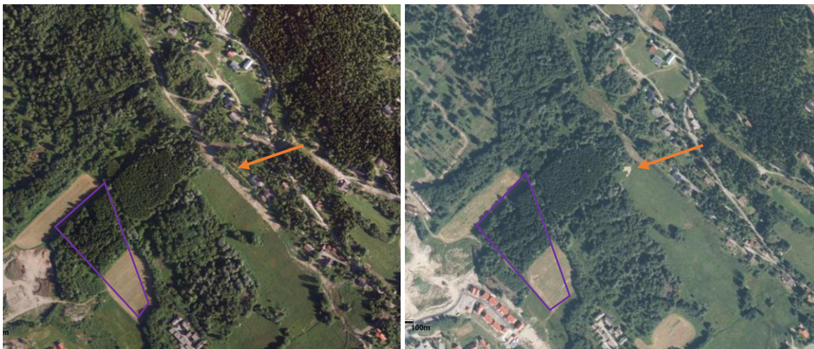
Figur 4 Flyfoto fra A) 2010 og B) 2013. I A) ser vi en vei eller grøft. I B) er denne delvis gjengrodd, men et jordskred er tydelig (pil) like nedenfor den grodde grøfta/veien.
