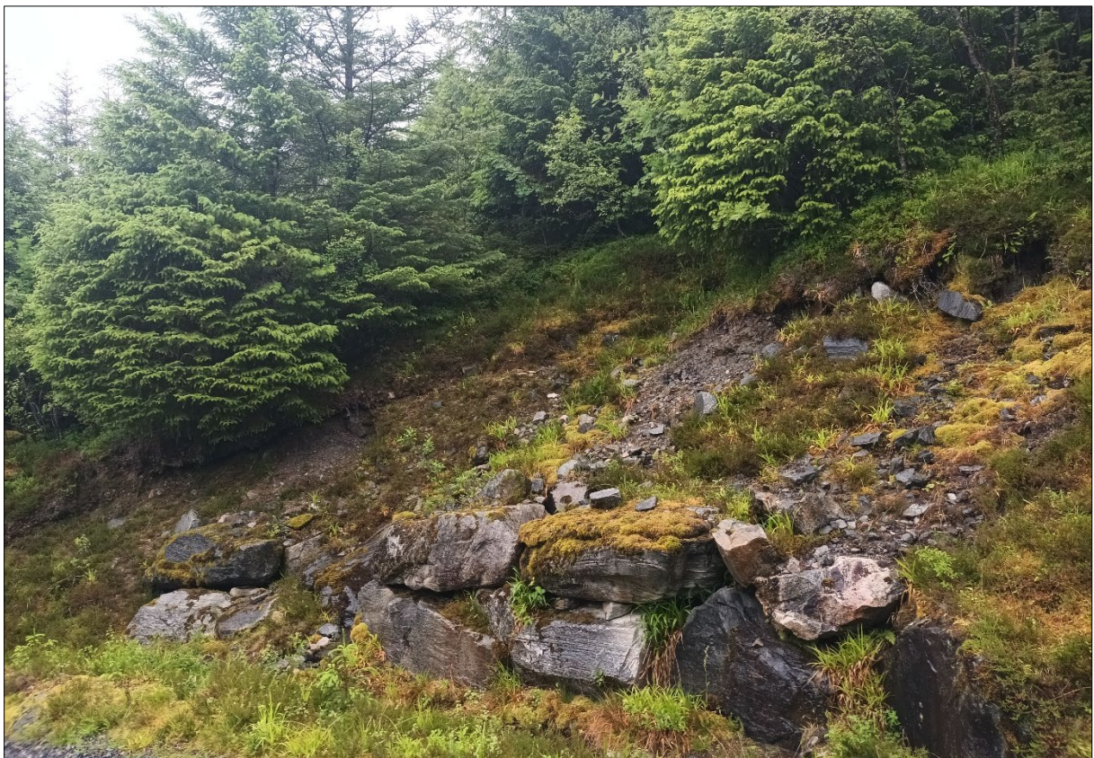
Figur 11: Bildet viser tykk moreneavsetning omtrent 190 moh. i øvre del av påvirkningsområdet. Lømassetykkelsen er større enn 1 m.
