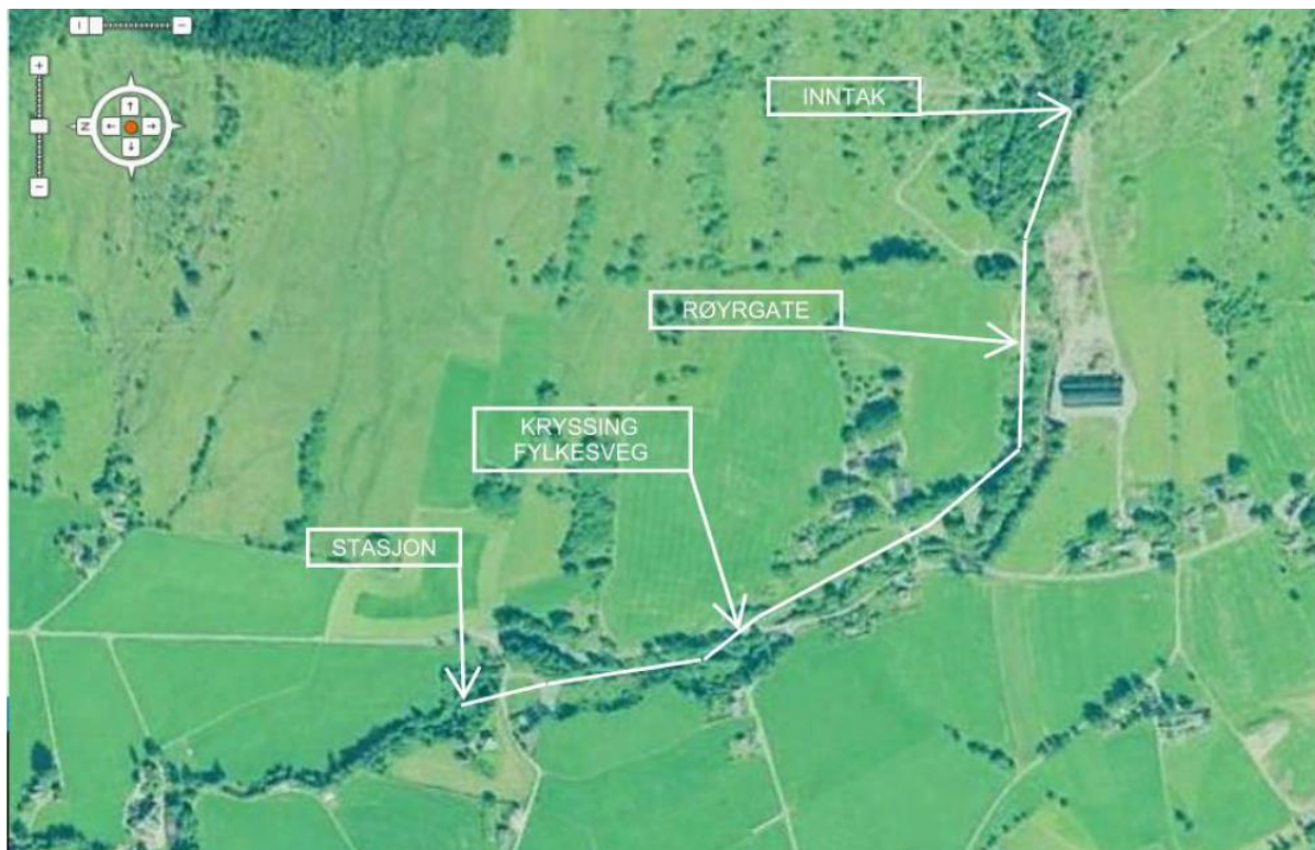
Figur 1. Utbyggingsskisse for Auno kraftverk. Frå Energi Teknikk AS.
