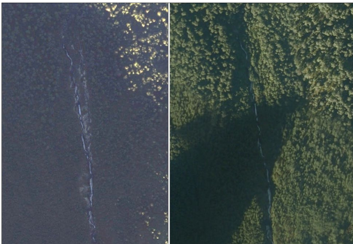
Figur 19: Samanstilling av flyfoto frå midtre del av Rygg-Kjørdalselva frå 2010 (høgre) og 2015 (venstre) viser at lausmassane i elveløpet har blitt reinska ein gong i denne perioden. Infopunkt 5. Vertikalfoto: norgebilder.no
