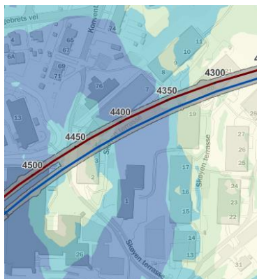
Figur 4-3. Viser et dypere parti nord-sør i området, der mørkere farge indikerer dypere til berg.
