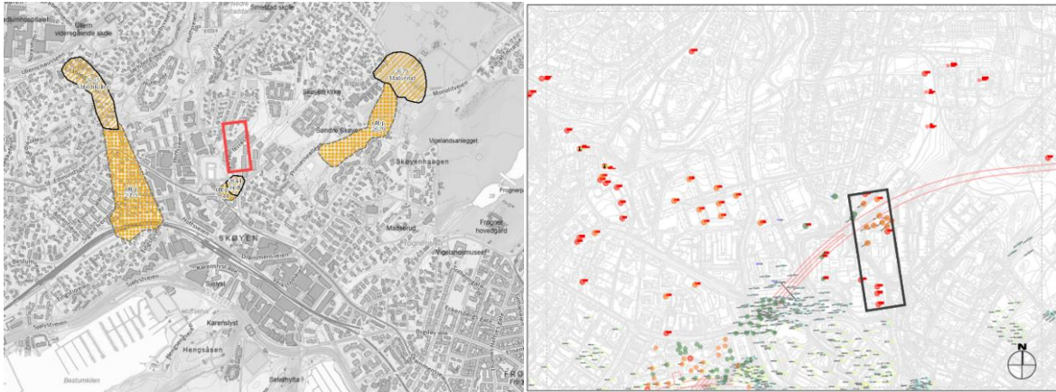
Figur 8-1. Venstre: Viser nærmeste kartlagte faresoner i området. Høyre: Omtrentlig markering av Skøyen terrasse, viser flere kartlagte kvikkleire-/sprøbruddspunkter i området.
