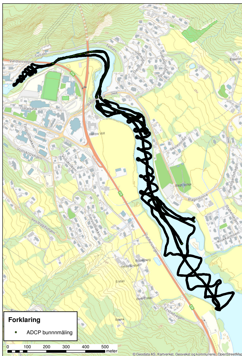
Figur 3-1 Oppmåling av elvebunn med ADCP fra båt, 19. sep. 2024.
