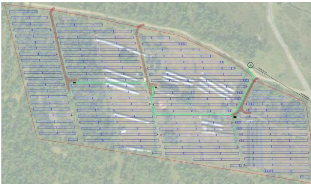
Figur 8: Situasjonsplan som viser hvordan området er planlagt. De blå rektanglene er et antall moduler på en festestruktur, røde bokser vekselrettere, grønne linjer 22 kV-kabler, brune felter viser veier fram til transformatorer. Rødt omriss er gjerdet rundt anlegget og den svarte linja nordøst er det eksisterende distribusjonsnettet der solkraftverket planlegges knyttet til. Tilknytningspunktet er vist med svart ring. (Innlandet Fornybar).
