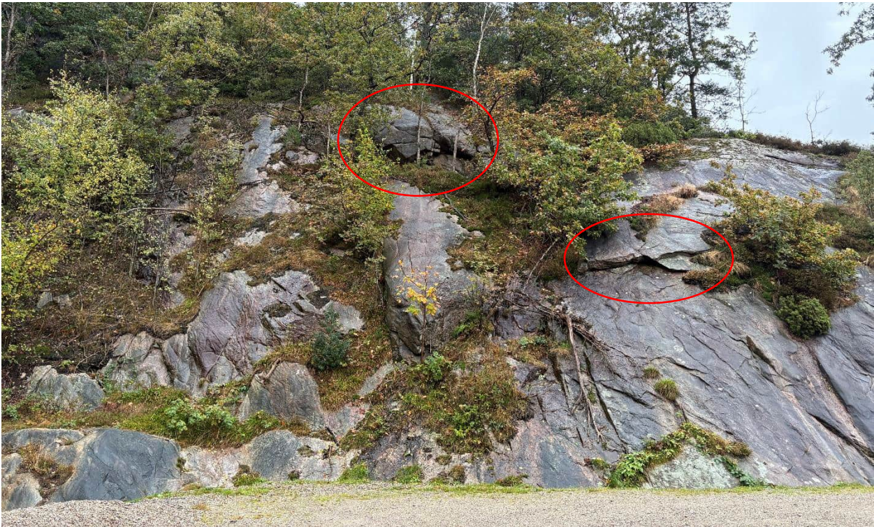
Bilde 3: Infopunkt 2 i Vedlegg 4. Bergskrent/glattskurt svaberg, med enkelte tilsynelatende avløste flak og blokker i størrelsesorden ca. 0,2-0,5 m 3 . Sett mot øst.
