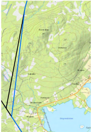
Figur 3-2. Traseen er flyttet noe lenger øst ved Skognesbotn. På det meste er traséen flyttet ca 196 meter lengre mot øst. Kilde: Norconsult.
