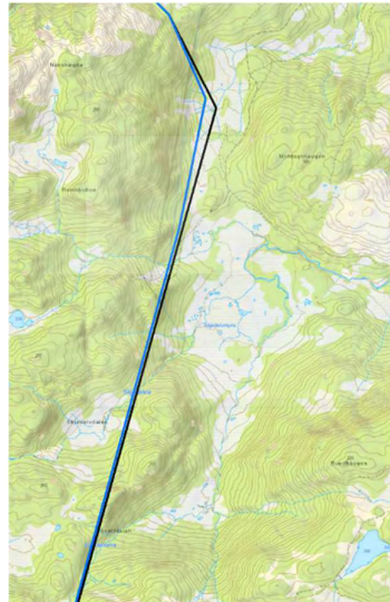
Figur 3-3. Ved Nonshøgda er traséen flyttet noe lengre vest. På det meste er traséen flyttet ca 75 meter lengre mot vest. Dette bl.a. for å unngå Skjellelvmyra. Kilde: Norconsult
