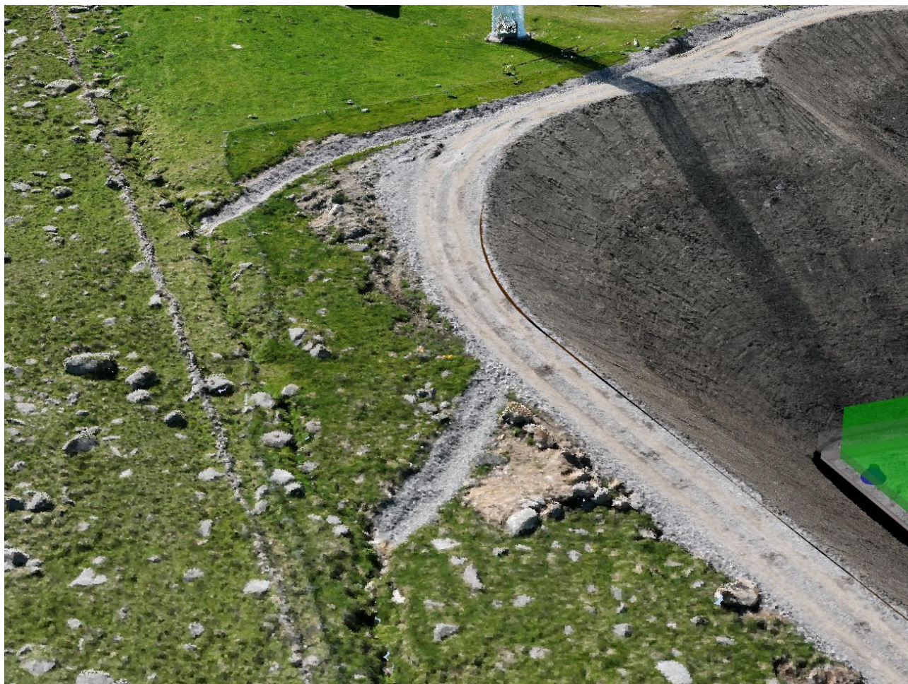
Figur 1-4. Dronebilde av omlagt bekkeløp som nå er lagt om til å renne ut i den sørligste bekken av innløpsbekkene til Stormyråna. Kilde: Norconsult Norge AS.
