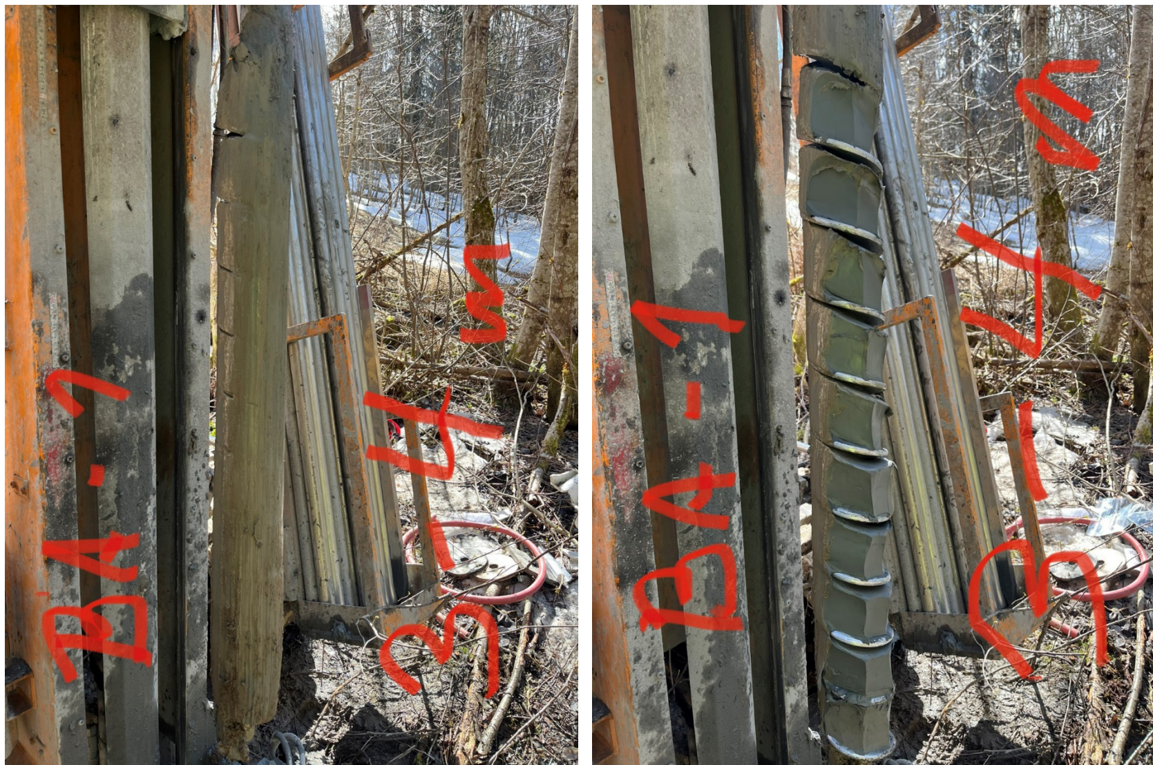
Figur 3-1 Naverboring ved BA-1, 3-4 meter. Venstre: optrukket prøvemateriale. Høyre: avskrapet materiale.
