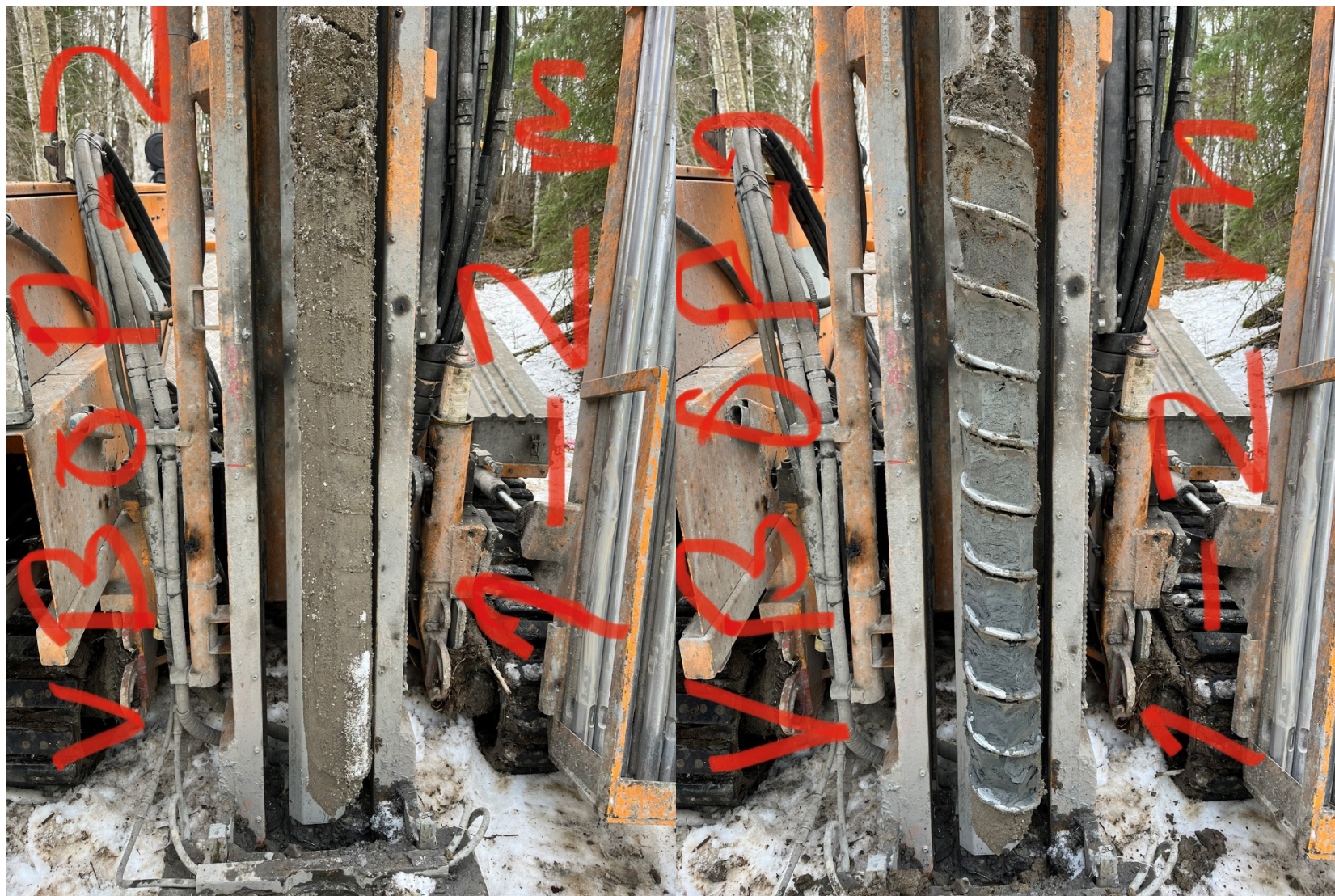
Figur 3-19 Naverboring ved VBOP-2, 1-2 meter. Venstre: opptrukket prøvemateriale. Høyre: avskrapet materiale.
