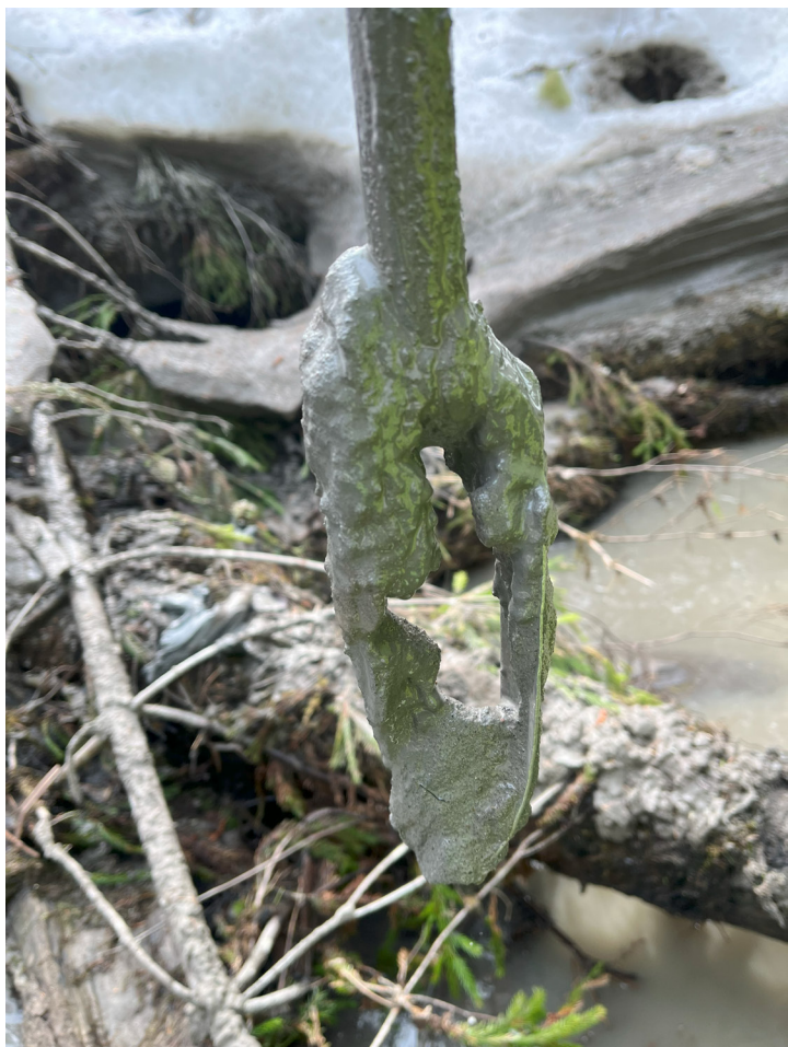
Figur 3-22 BA-NAV4 0-1.5m siltige, sandige masser over leire. Mellom prøvetakingene (2 og 3 meters dybde) var det også lag av silt og sand.
