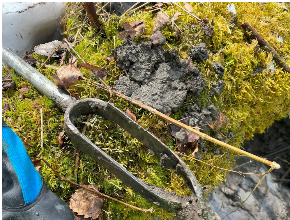
Figur 3-21 Skovling ved BA-NAV3, 0.3 meter (ikke hentet prøve fra her). Sandlag over leire, med diverse kvister og stokker. Prøvetakingen ved 0.8 meter var etterfulgt av meget hardt lag eller stukk som hindret videre skovling.
