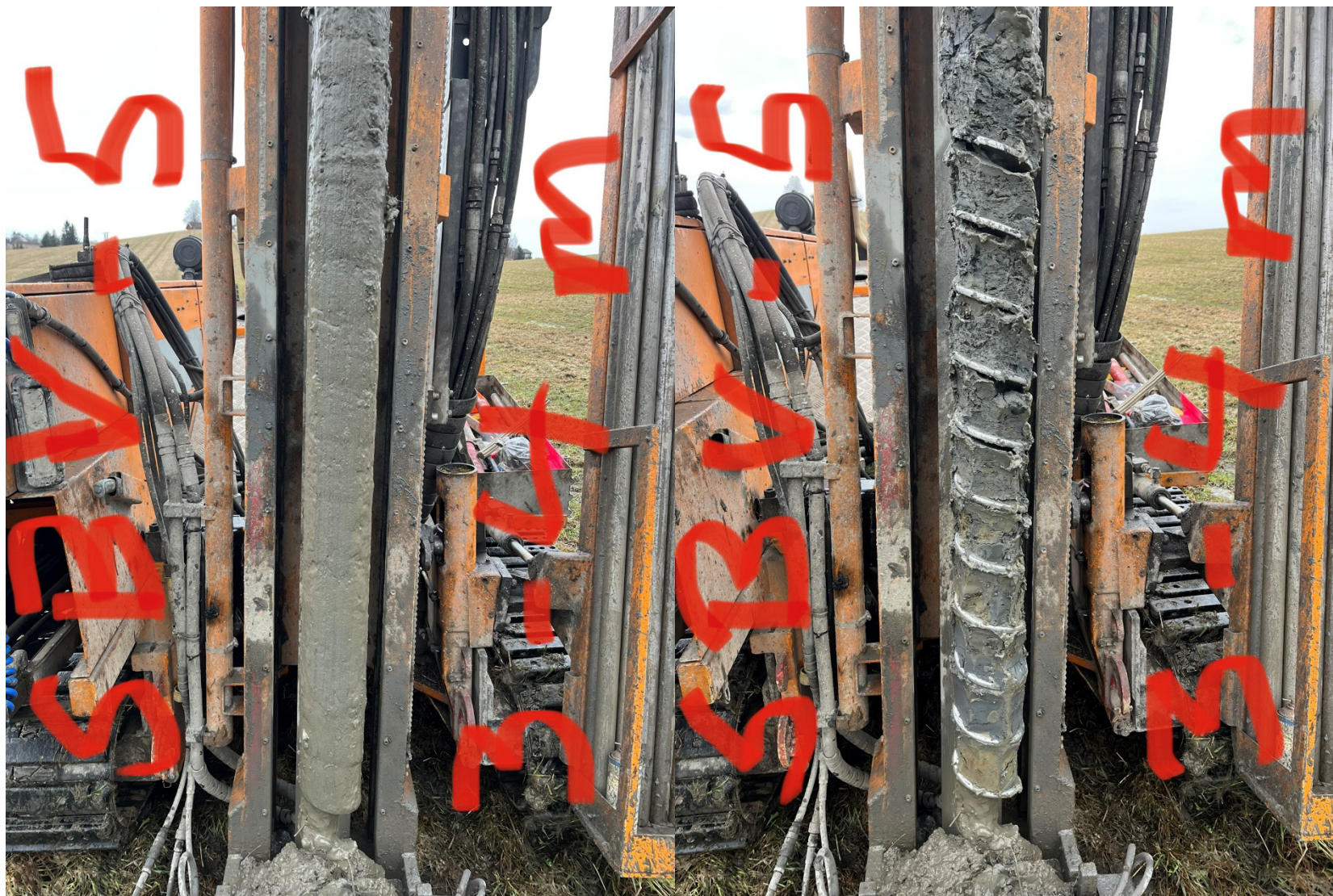
Figur 3-16 Naverboring ved SBV-5, 3-4 meter. Venstre: opptrukket prøvemateriale. Høyre: avskrapet materiale.
