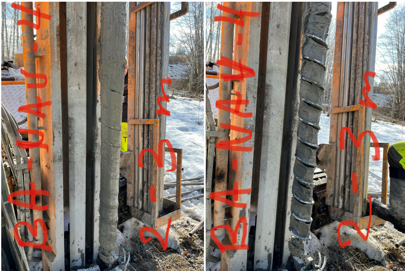
Figur 3-4 Naverboring ved BA-NAV5 (merk navneendring), 2-3 meter. Venstre: opptrukket prøvemateriale. Høyre: avskrapet materiale.
