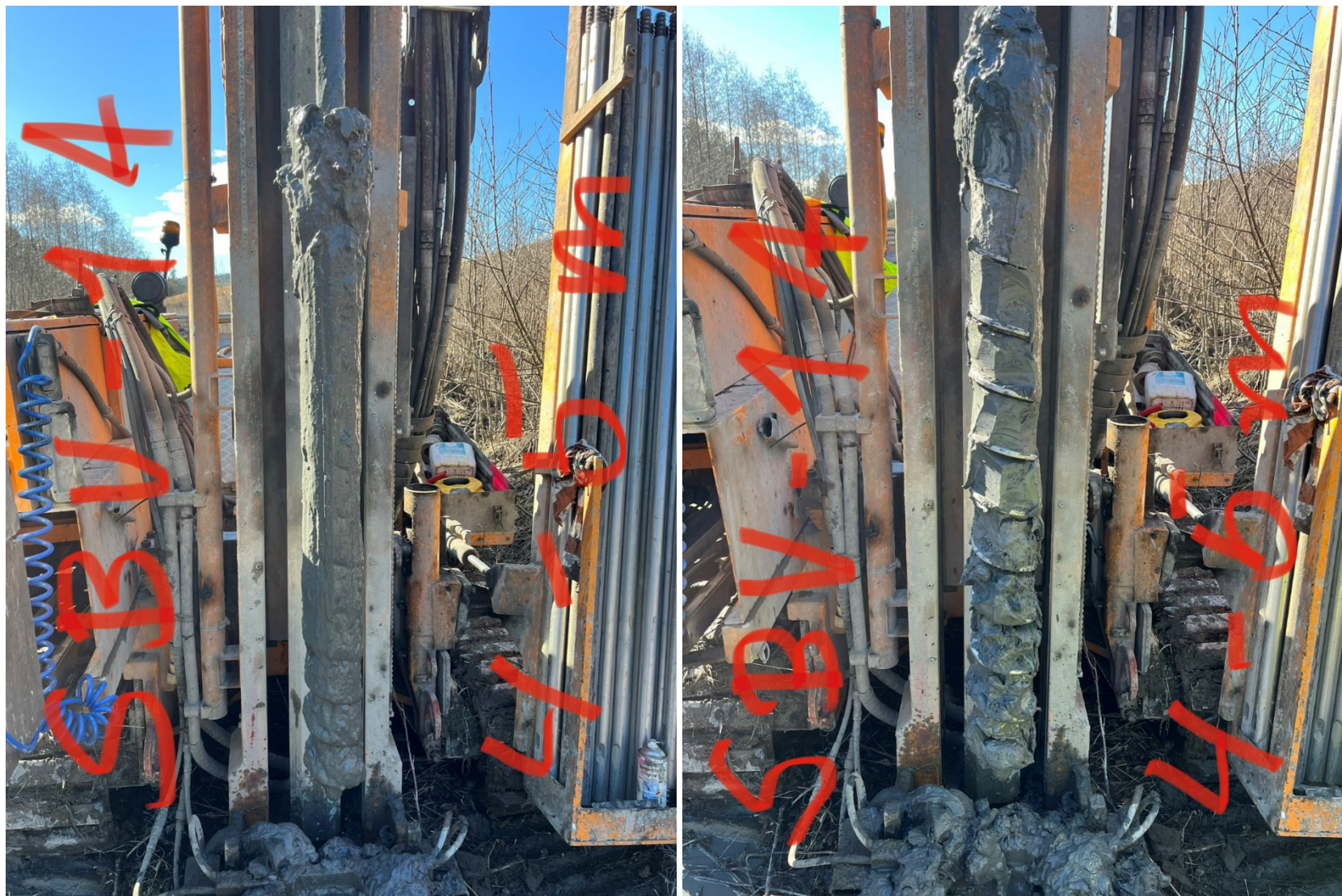
Figur 3-10 Naverboring ved SBV-1, 4-5 meter. Venstre: opptrukket prøvemateriale. Høyre: avskrapet materiale.
