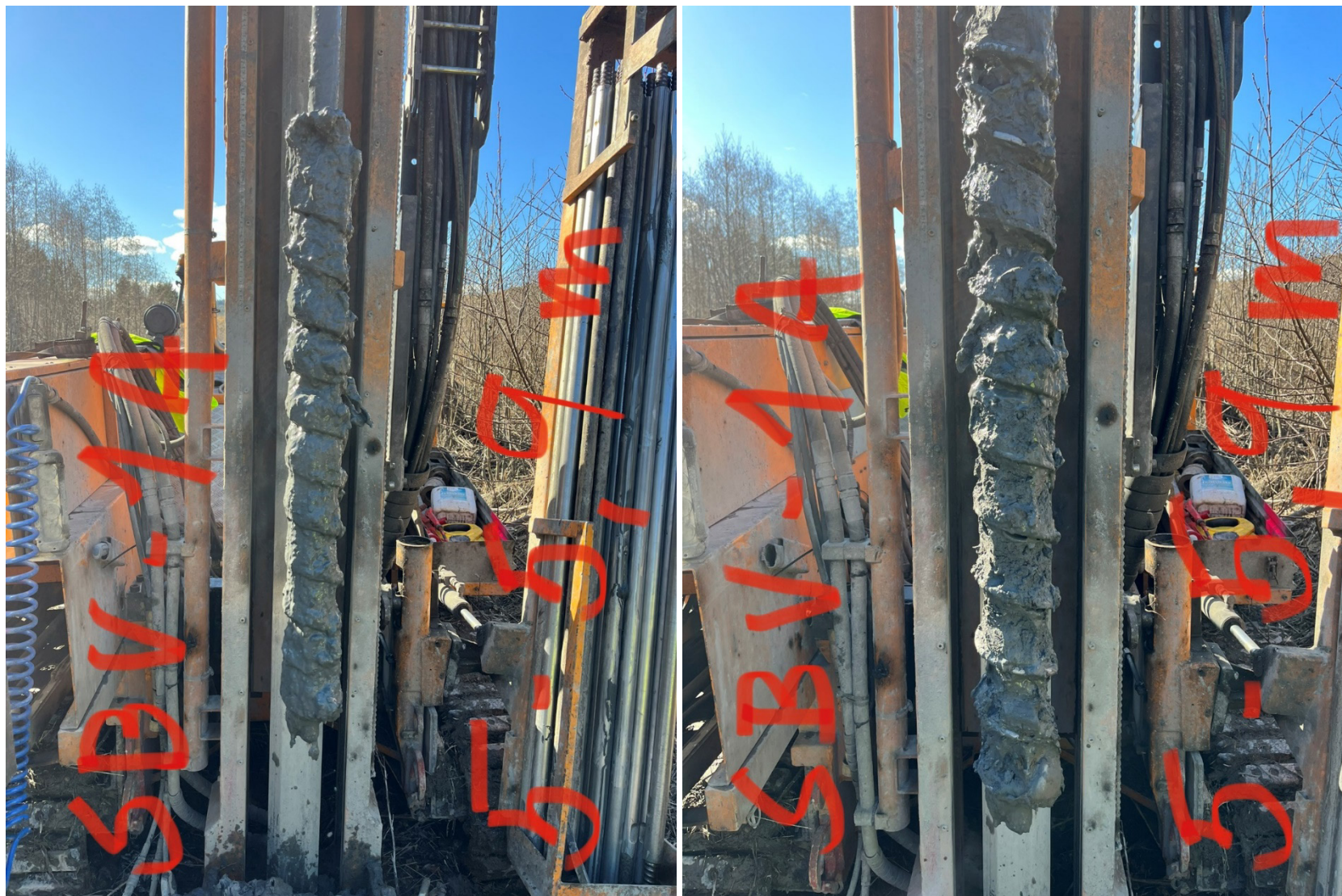
Figur 3-12 Naverboring ved SBV-1, 5-6 meter. Venstre: optrukket prøvemateriale. Høyre: avskrapet materiale.
