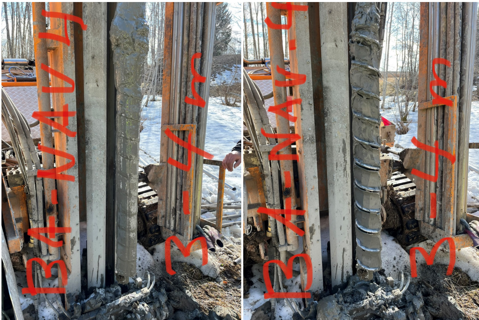
Figur 3-5 Naverboring ved BA-NAV5 (merk navneendring), 3-4 meter. Venstre: opptrukket prøvemateriale. Høyre: avskrapet materiale.
