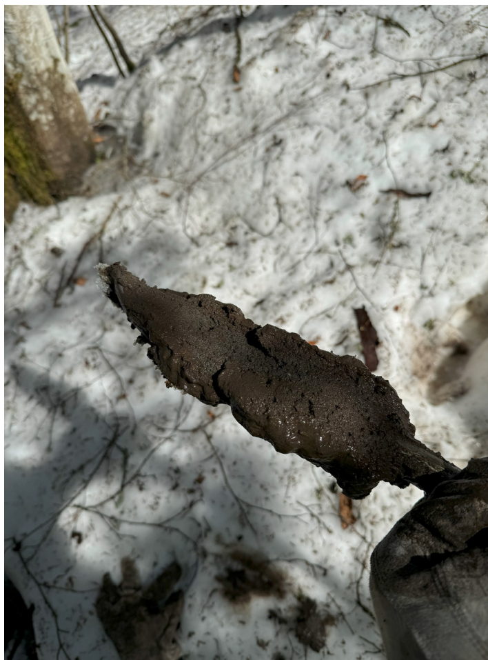
Figur 3-23 Skovling ved VBOP-NAV3, 1 meter, prøve 1. Det var et meget hardt 5-10 cm lag ved ca. 0.8 meters dybde. Ellers mye organisk materiale, kvister ol.
