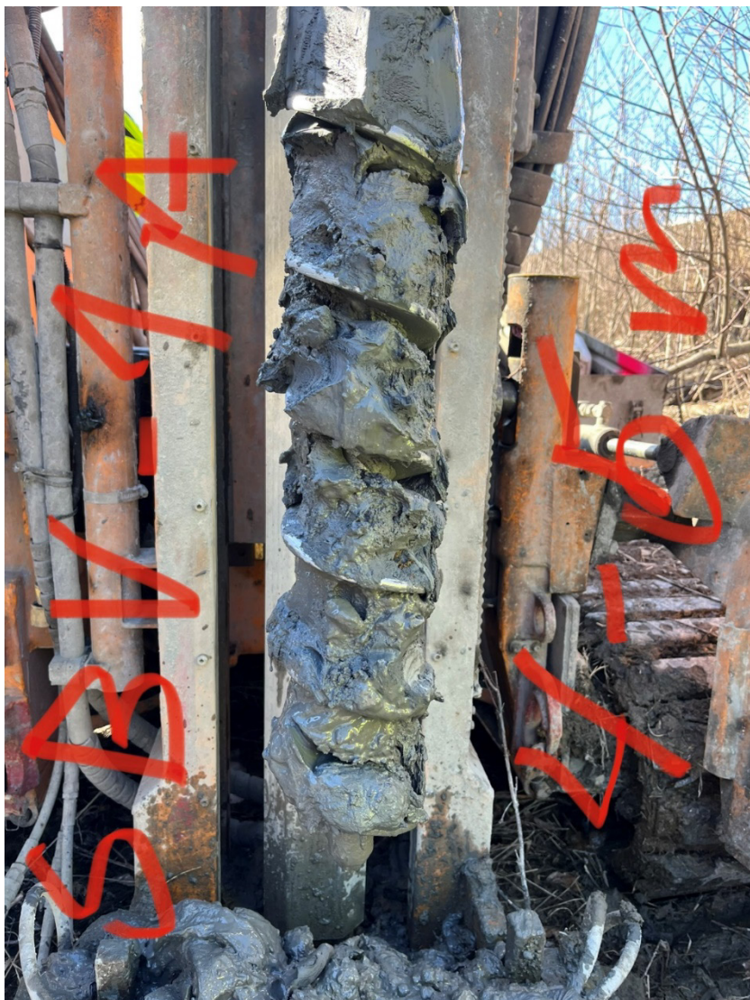
Figur 3-11 Naverboring ved SBV-1, detaljbilde av nedre 40 cm av naveren, avskrapet materiale.
