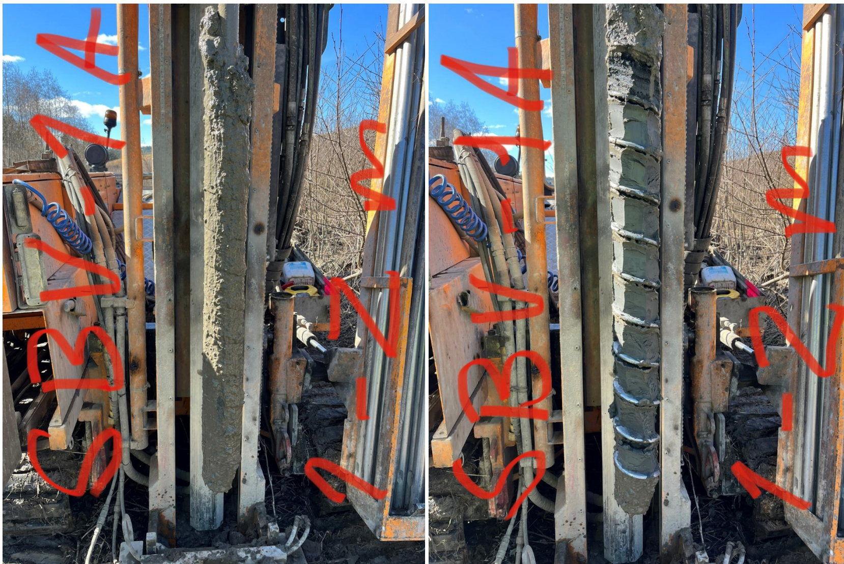
Figur 3-8 Naverboring ved SBV-1, 1-2 meter. Venstre: optrukket prøvemateriale. Høyre: avskrapet materiale.
