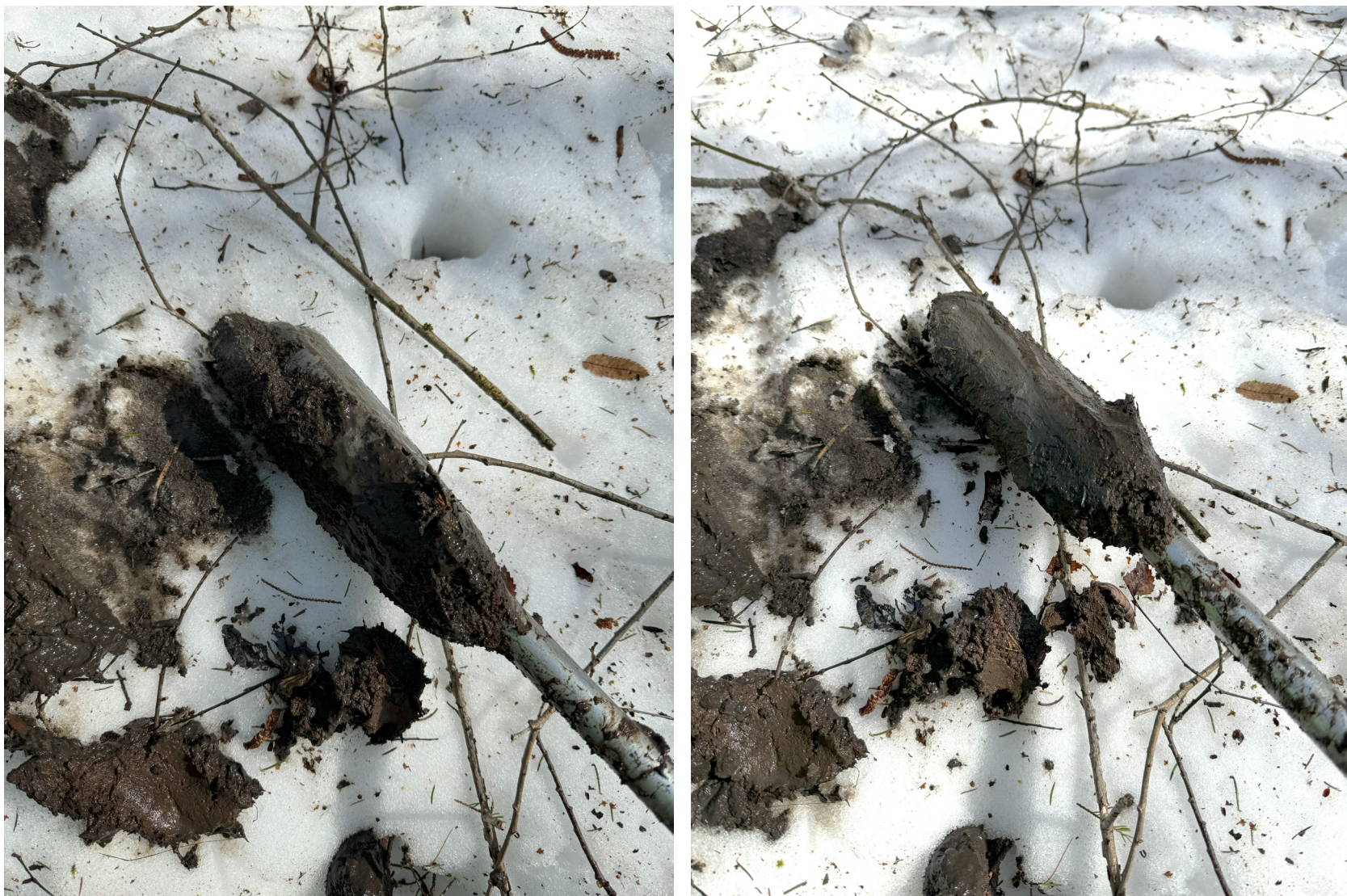
Figur 3-28 Skovling ved VBOP-NAV4 prøve 3, 1.75m. Venstre: opptrukket prøve. Høyre: avskrapet prøve.
