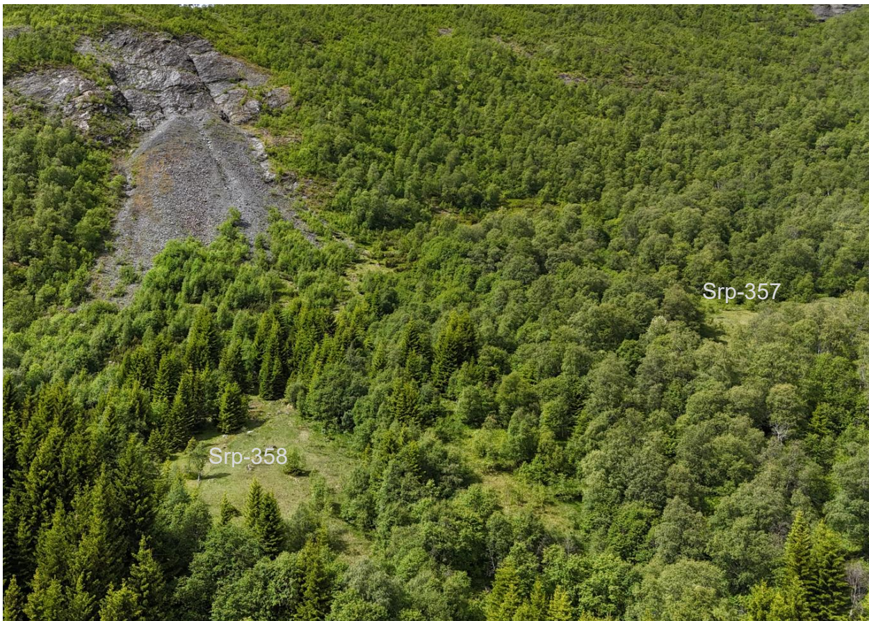
Figur 8. Åpninger i skogen som utgjør mulig løsneområder for sørpeskred. Avsetningen øverst til venstre er antagelig en tipp etablert i forbindelse med kraftutbyggingen i området.
