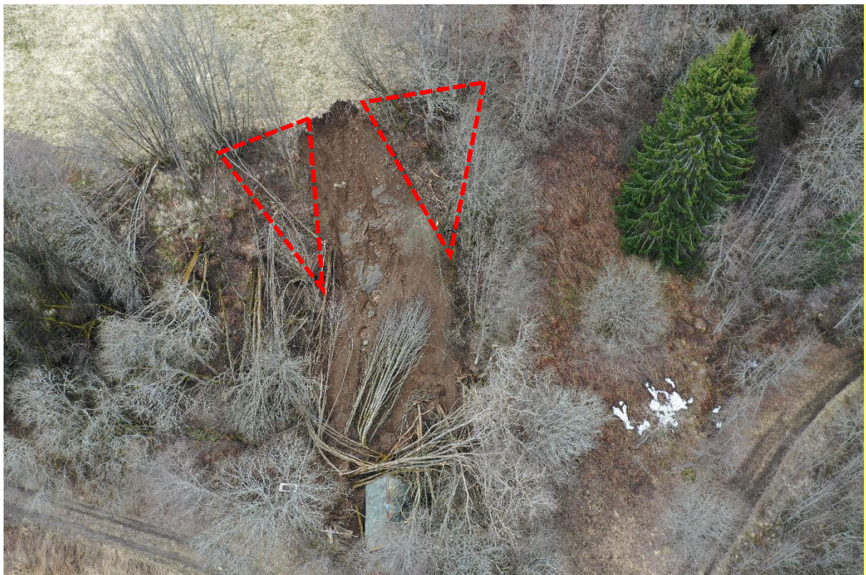
Figur 13: Areal for fjerning av masser (A) eller erosjonssikring (B).
