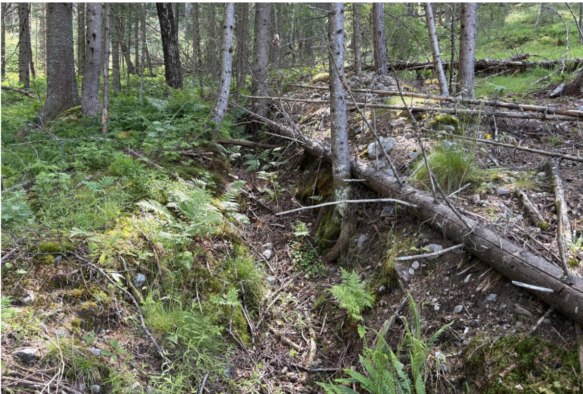
Bilde 9: Infopunkt 4 i Vedlegg 4. Grøft som er gravd i morenemasser. Ca. 0,5 m dyp. Ingen tegn til nylig vannføring/erosjon i grøfta. Set mot sørøst.
