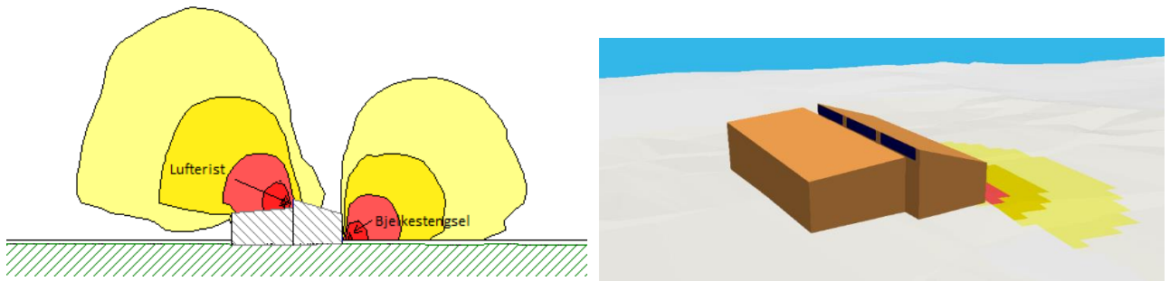
Figur 3: Til venstre: snitt av trafobygg med støytbredelse ut rister. Til høyre ses modell av typisk trafostasjon i perspektiv.
