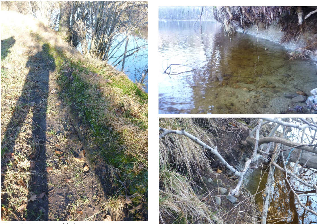
Figur 7: T.v.: sprekk langs topp av terrasse. T.h.: Leire i dagen i elvbredden (ø), erosjon og veltet tre (n).
