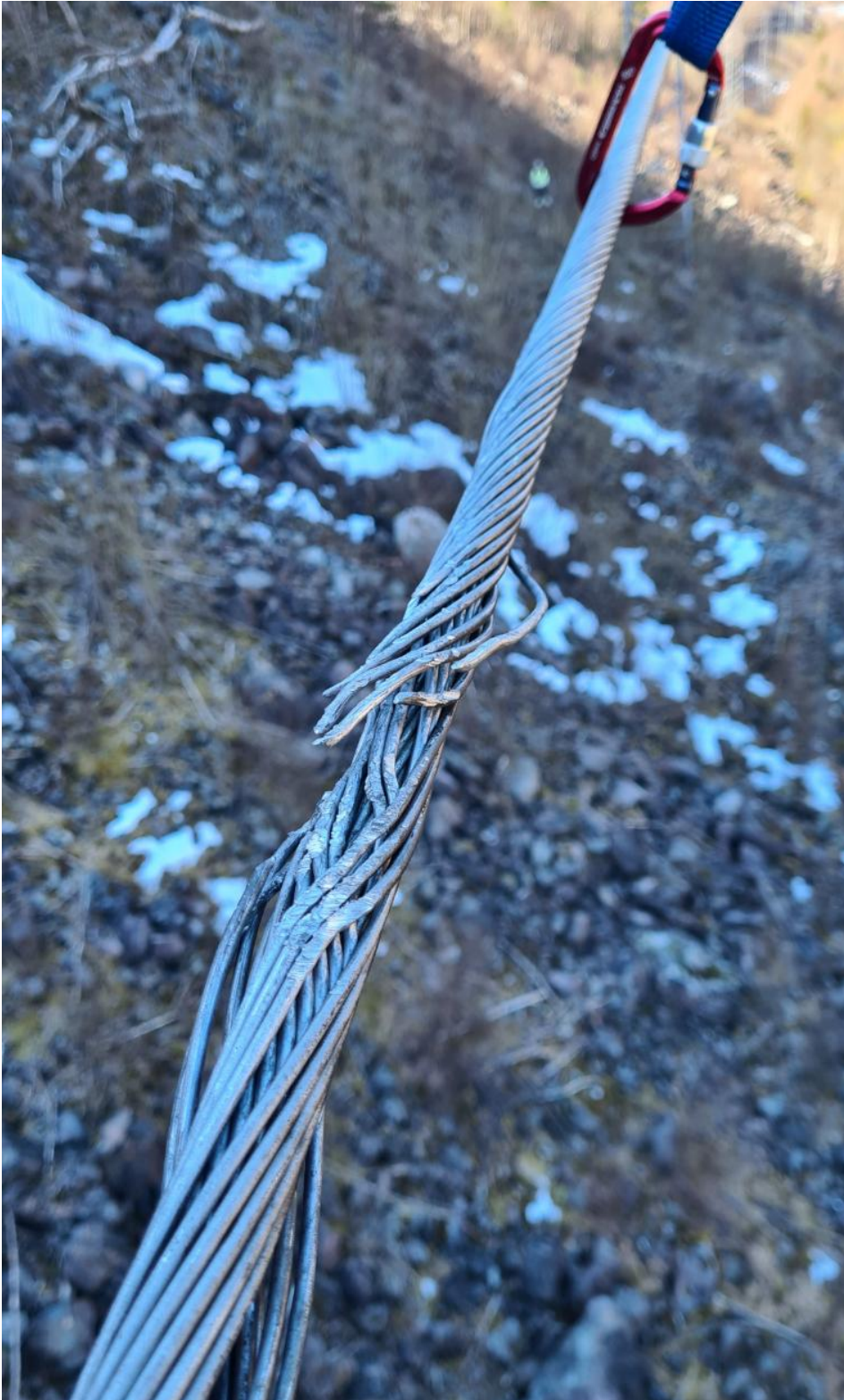
Figur 1-8: Skade på wire 12 m over bakken som følge av steinsprang. Bilde tilsendt fra Lede AS.
