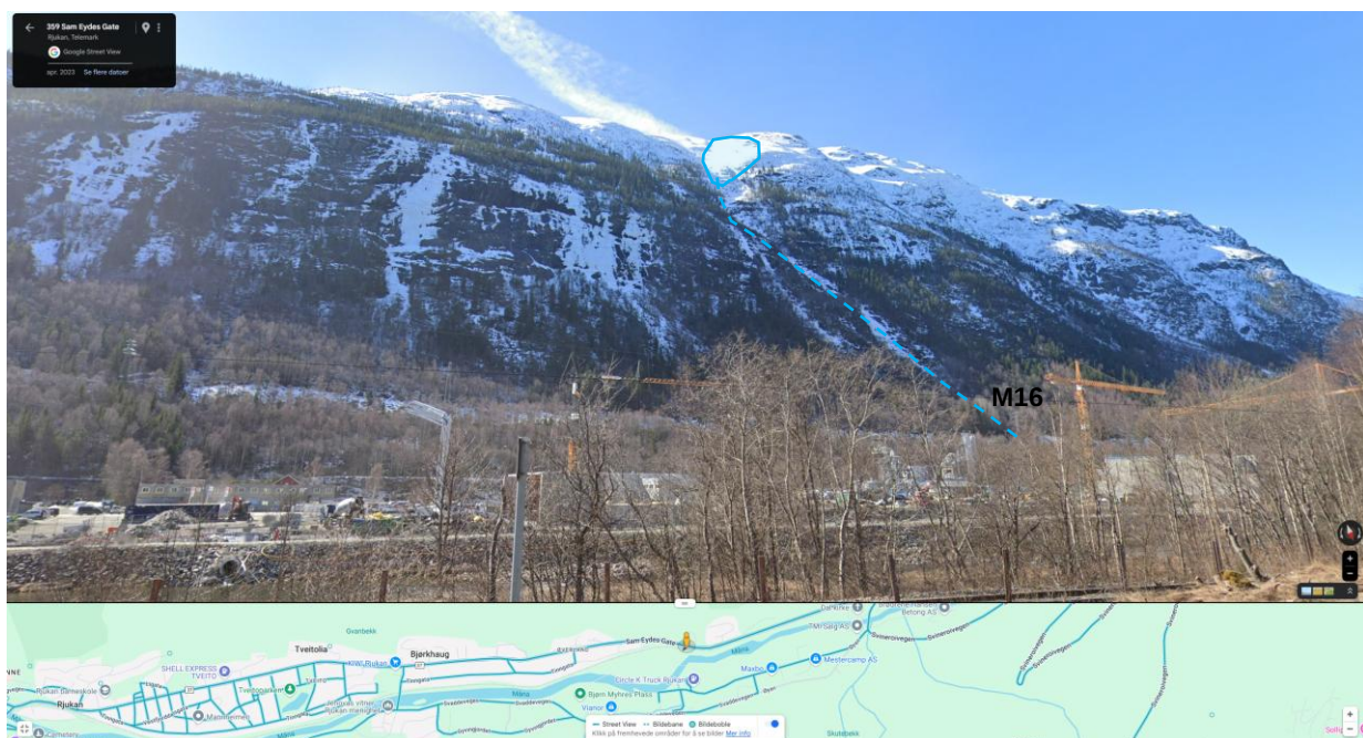
Figur 2-19: Google-streetview som viser fjellsiden ovenfor mast M16 til og med M19. Mast M16 skimtes på bildet. Bildet viser at det legges seg snø i øvre deler av fjellsiden hvor det er beskrevet løśnieområder for snøskred i tidligere skredfarevurderinger. Løśnieområder for snø er markert med blå polygon. Antatte skredbaner for snø er markert med blå stiplede linjer.
