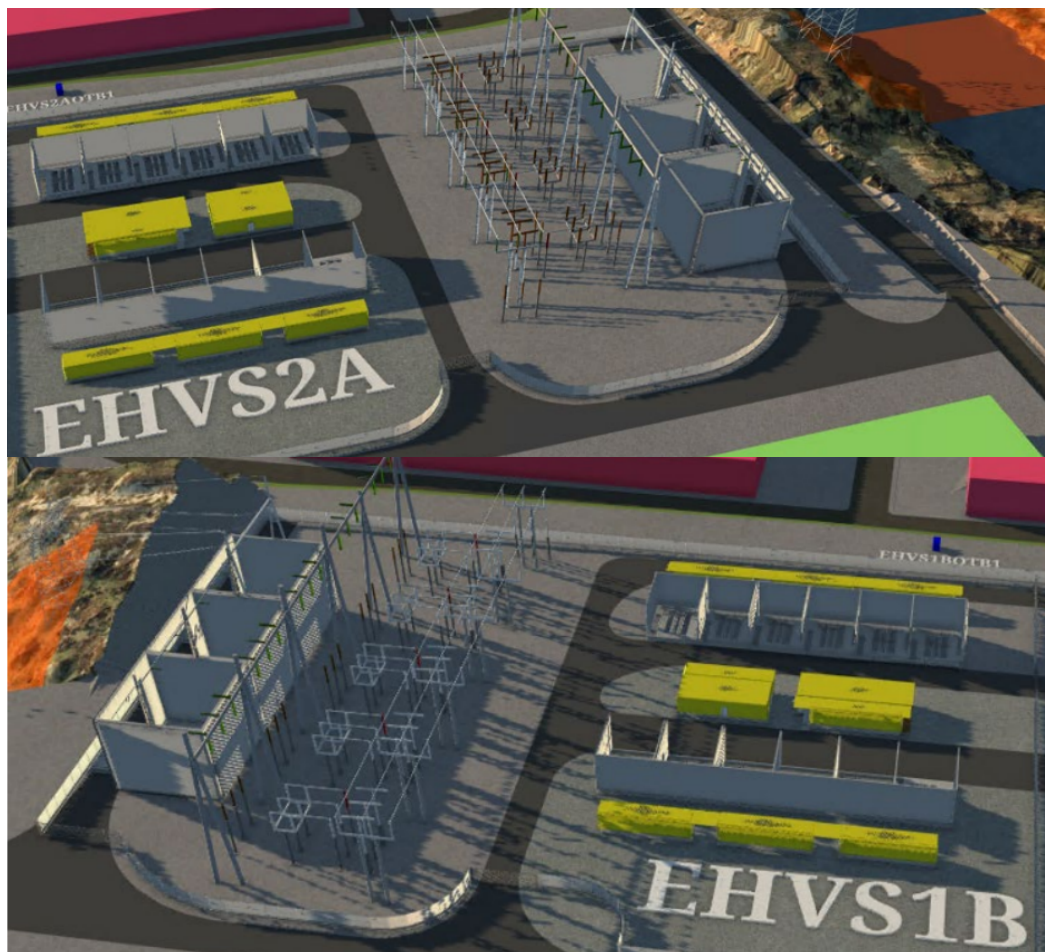
Figur 1: N01 Utilities har søkt om to identiske transformatorstasjoner EHVS2A og EHVS2B for nedtransformering fra 420 kV. Gjerde for stasjonsområdet er vist med heltrukken sort strek som går rundt de elektriske anleggene.
