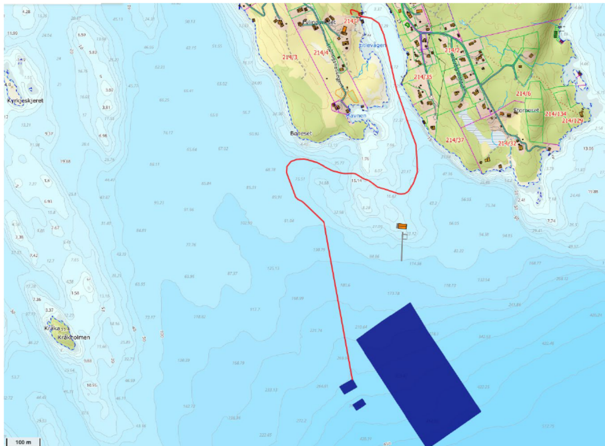
Figur 1. Kart over den planlagte kabeltraseen med total lengde 1730 meter vist som rød strek. Kilde: Eide Fjordbruks konsesjonssøknad
