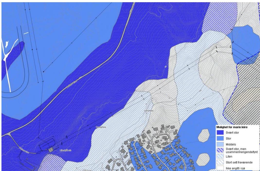
Figur 2. NGUs kart for mulighet for marin leire er basert på løsmassekartet og angir svært stor sannsynlighet for forekomst av marin leire ved vestlig del av trasé, og lav/stort sett fraværende for østlig del av trasé i områder som sammenfaller med angitt morene (kilde: https://geo.ngu.no/kart/losmasse_mobil/?lang=nor&map=9 ).
