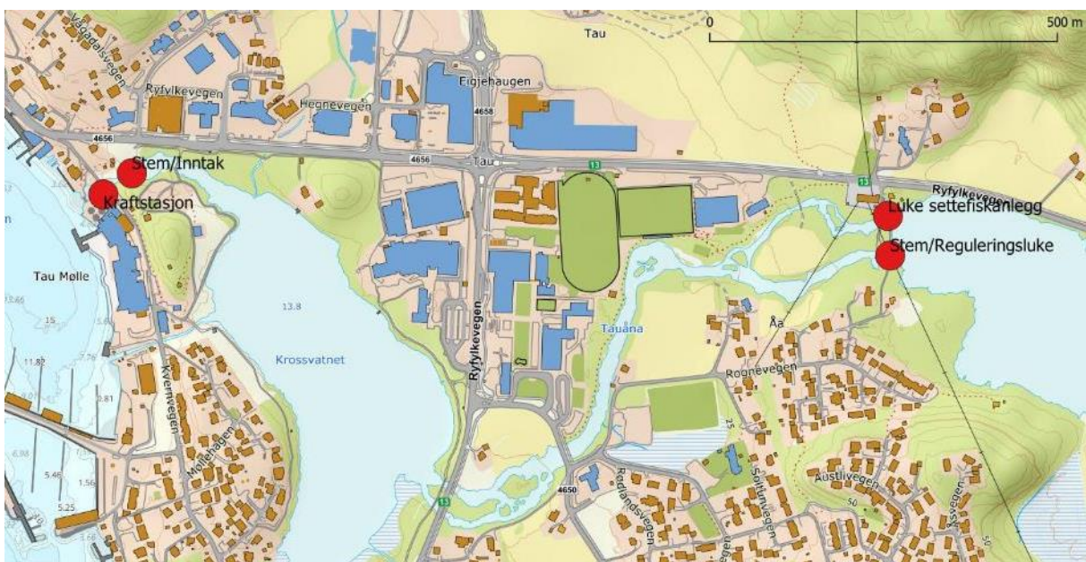
Figur 2. Eksisterende kraftverk har inntak på kote 13 i Krossvatnet. Det er reguleringsmulighet ved demning i vestre kant av Bjørheimsvatnet. Når det er drift slippes 10,5 m 3 /s gjennom luka i dammen, og det meste av Tauåna
