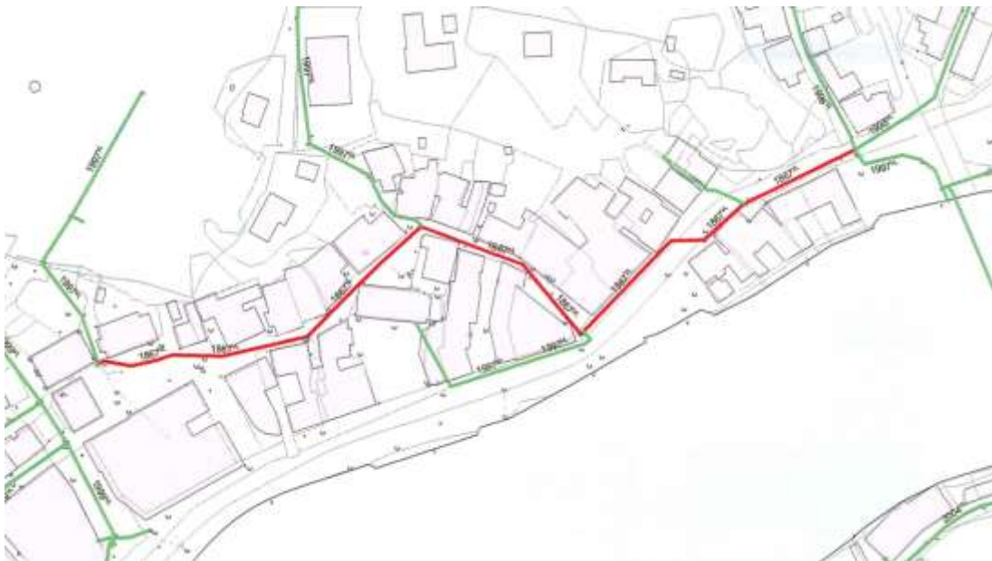
Fig 4: Hovedledning fra 1867 må skiftes fra brokrysset til Adolf Tidemanns plass.
