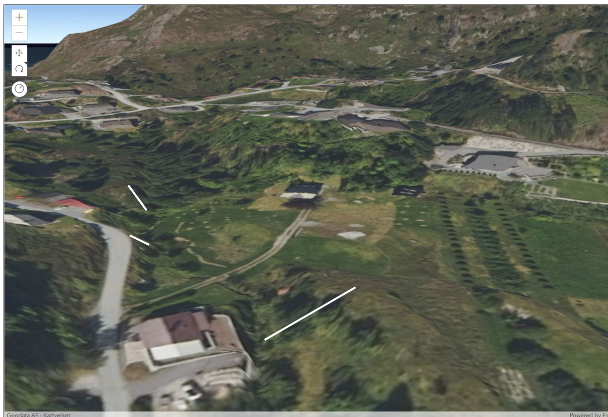
Figur 10: 3D fremstilling fra flyfoto fra sørlige del av tiltaksområdet som viser fast fjell i dagen, sett fra sørvest. De hvite strekene indikerer kritisk skråning 1-3, og i disse områdene er det fast fjell. Vertikalfoto: norgebilder.no
