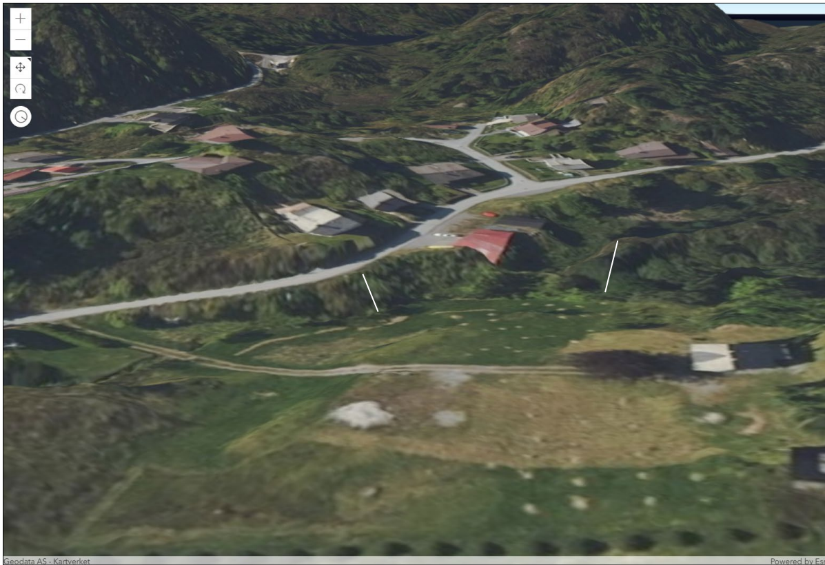
Figur 11: 3D fremstilling fra flyfoto fra sørlige del av tiltaksområdet som viser fast fjell i dagen, sett fra nordøst. De hvite strekene indikerer kritisk skråning 2-3, og i disse områdene er det fast fjell. Vertikalfoto: norgebilder.no
