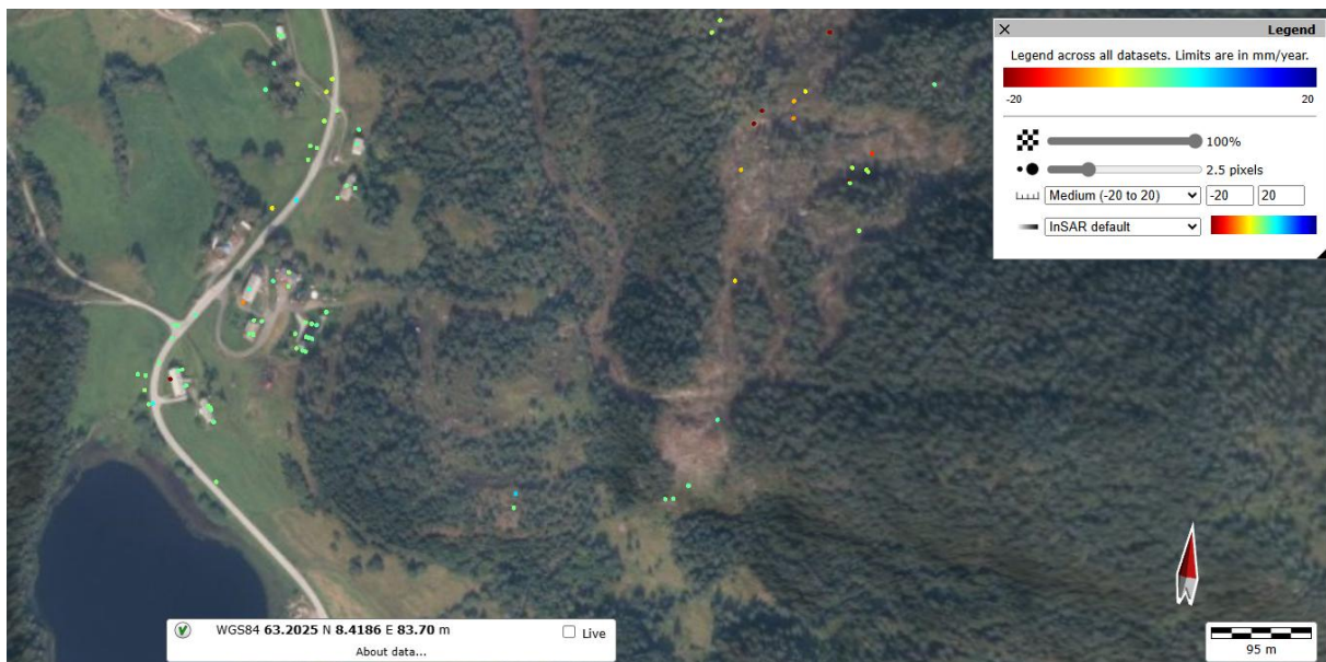
Figur 21 Registrerte bevegelser fra målinger med InSAR radar.
