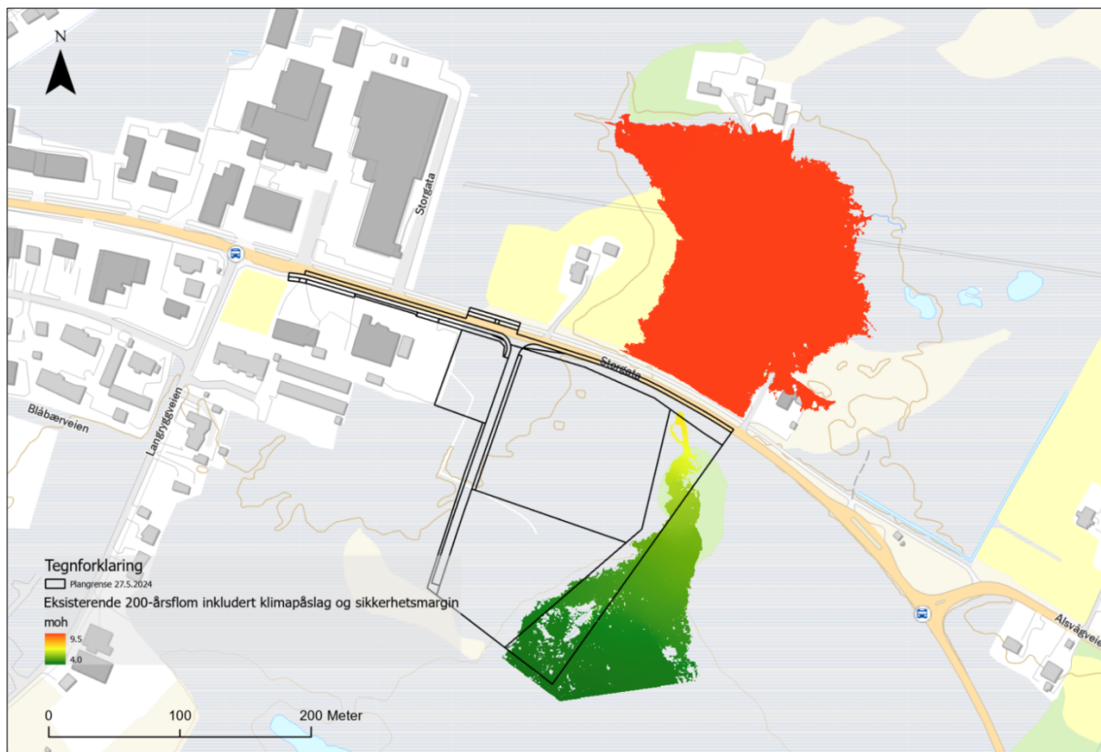
Figur 4-3. 200-årsflom inkludert klimapåslag og sikkerhetsmargin for eksisterende situasjon
