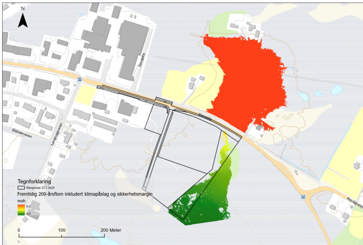
Figur 4-5. 200-årsflom inkludert klimapåslag og sikkerhetsmargin for fremtidig situasjon
