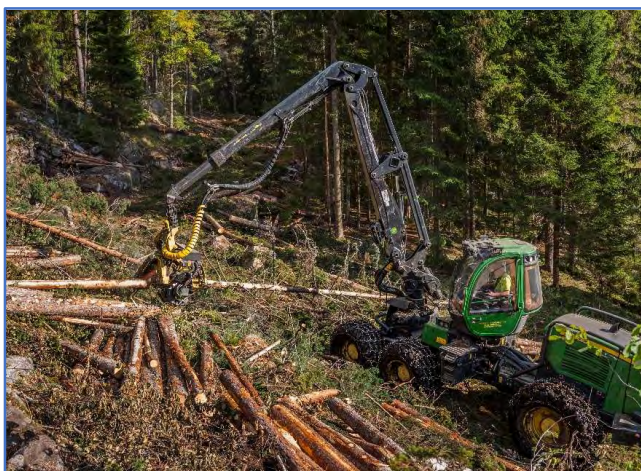
Figur 3-12. Rydding av skog i ledningstraseene gjøres i hovedsak med skogsmaskiner slik skogbruket driver i dag. Eksempel på ryddebelte langs kraftledninger.
