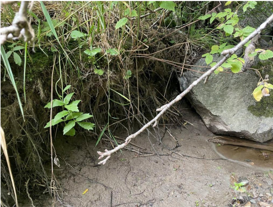
Figur 3-10: Punkt SV3. Tydelig undergraving, 50-70 cm høy og ca. 30 cm dyp.
