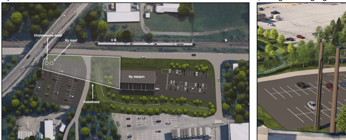
Figur 5-3: Illustrasjon av masteplasseringer og omtrentlig trasé for jordkablene fram til ny stasjon (venstre) og visualisering av de to mastene i driftsfasen (høyre).
