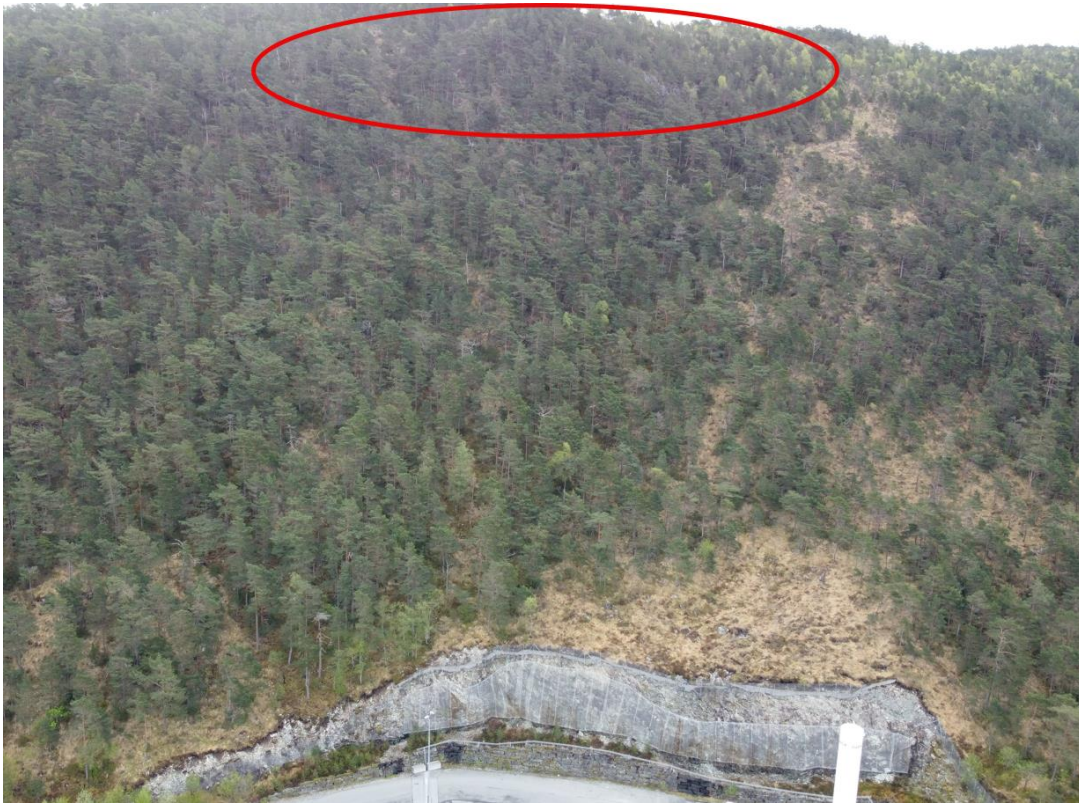
Figur 7. Oversikt over løsneområde for steinsprang (markert i rødt) sørøst i påvirkningsområdet.
