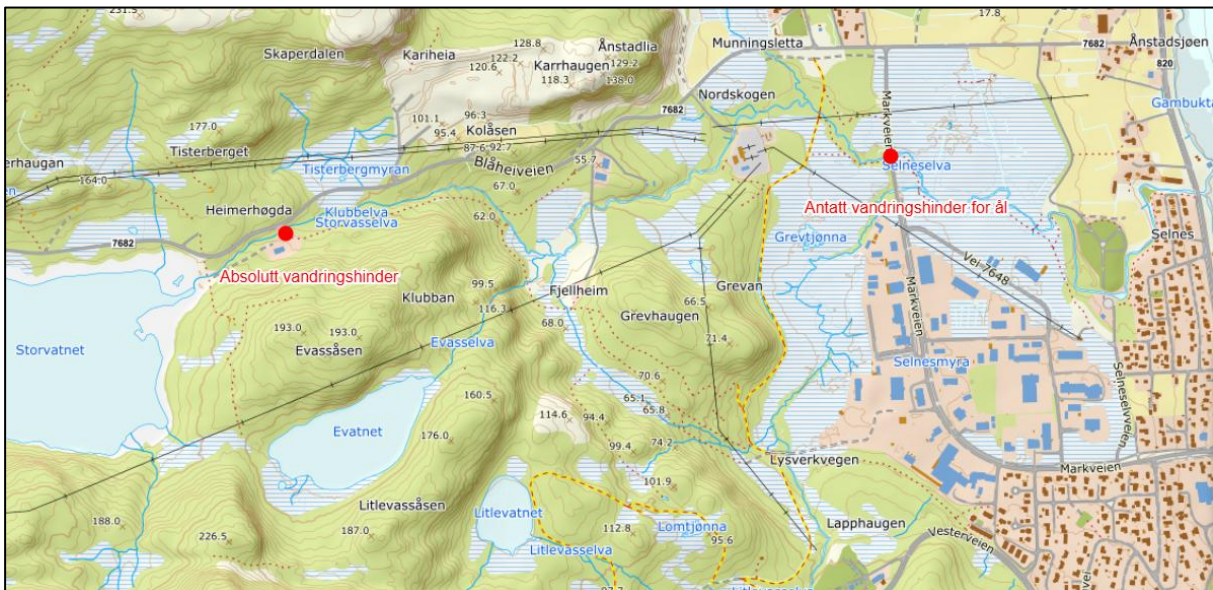
Figur 3-19 Røde punkt viser de to kulvertene omtalt i teksten: Absolutt vandringshinder under veien inn til vannbehandlingsanlegget og kulvert under Markveien som kan være oppgangshindrende for ål.
