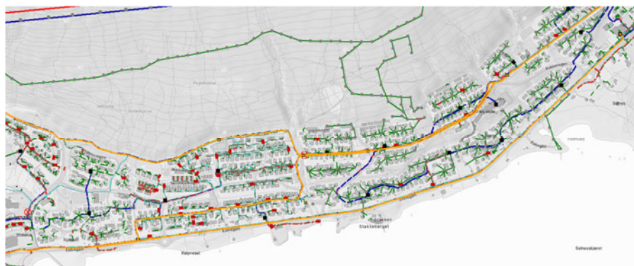
Figur 5: Kabler som er utkoblet i modellen. Ligger som redundans. Disse strekker seg rett igjennom området vist i figuren.
