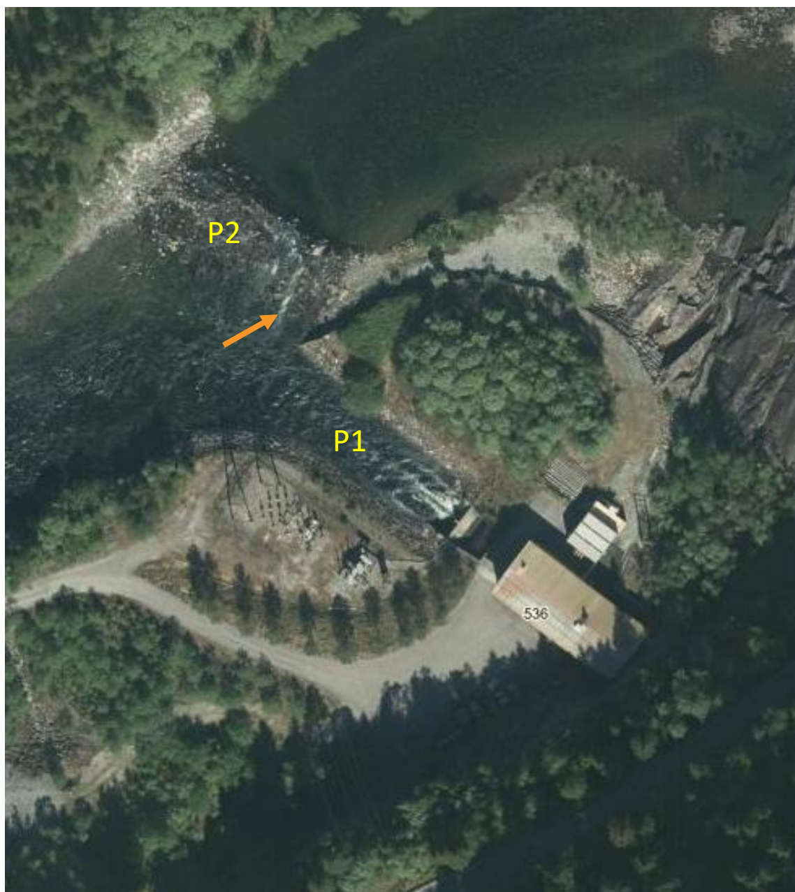
Figur 4. Oversikt over samløpet avløpstunnel fra Hellandsfoss kraftverk og steinterskel (P1 og P2). Oransje pil angir lokalisering av strømkonsentrator gjennom terskelen (Figur 5) (norgebilder.no).
