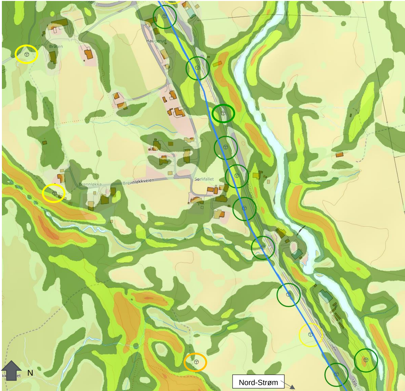
Figur 8 Oversiktsbilde med terrenghelning, borpunkt med tolket kvikkleire og skissert va-trase. Gul sirkel indikerer leire, oransje sirkel er antatt sprøbrudd og rød er påvist sprøbrudd. Grønn er enten påvist ikke sprøbrudd eller tolket å ikke inneholde leire..
