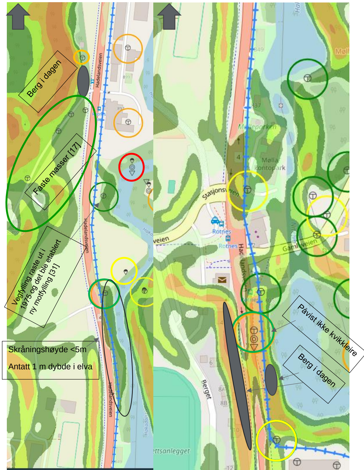
Figur 14 Oversiktsbilde med terrenghelning, borpunkt med tolket kvikkleire og skissert va-trase. Gul sirkel indikerer leire, oransje sirkel er antatt sprøbrudd og rød er påvist sprøbrudd. Grønn er enten påvist ikke sprøbrudd eller tolket å ikke inneholde leire.
