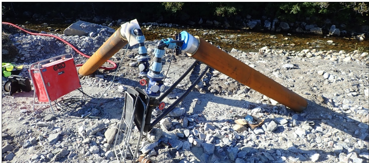
Figur 9. Bilde av produksjonsbrønnene (B1 og B2). Brønnene står på flomvollen. Haugaelva strømmet i bakgrunnen. (Foto: Asplan Viak, 2019).
