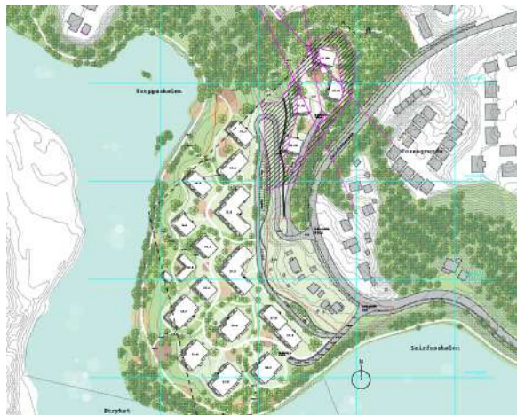
Fase 3 – Etablering av motfyllinger og fyllinger utenfor kjellerareal i ravinedalen
