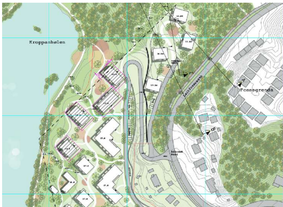
Figur 10-3 Omtrentlig omfang av masseutskifting på tomta.
