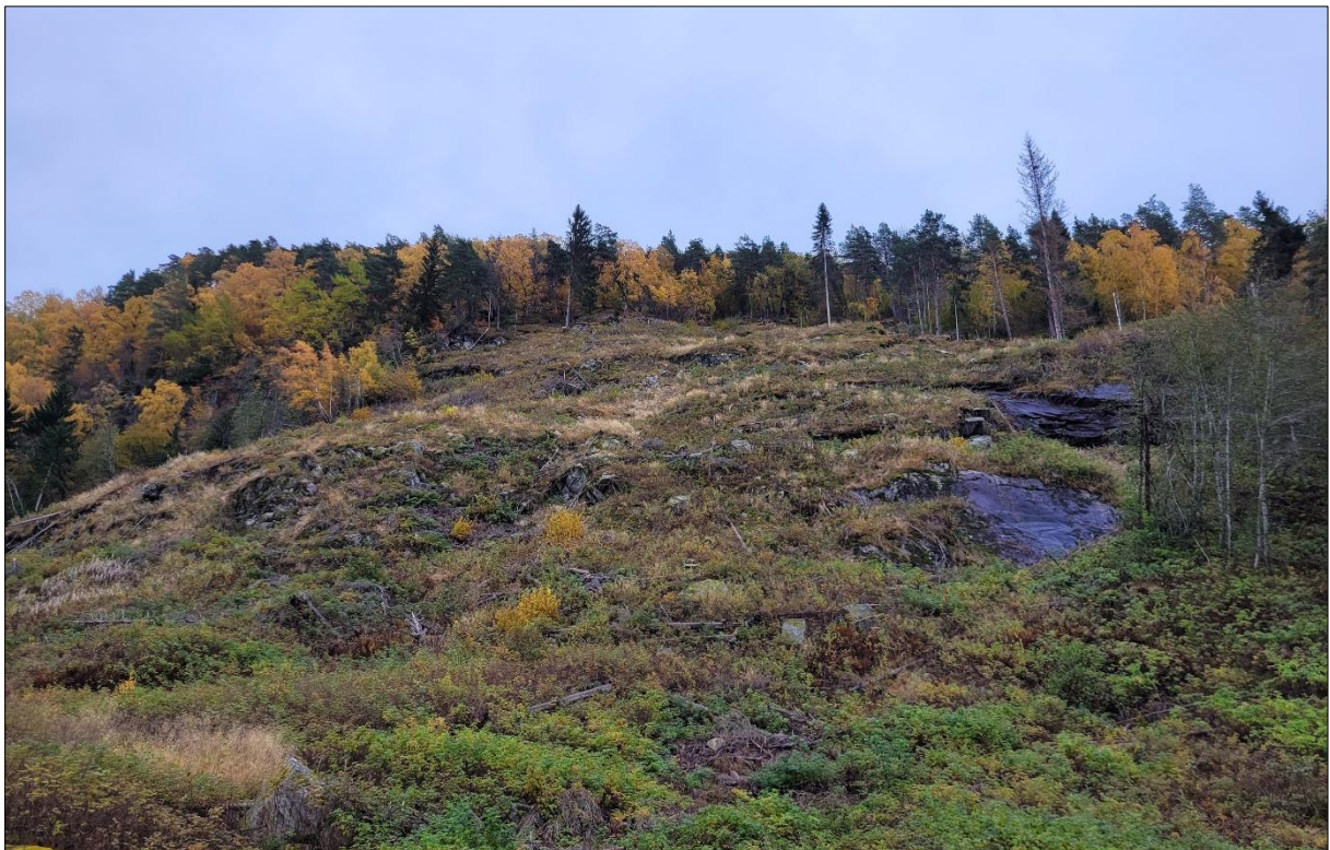
Figur 8: Fjell i dagen av gneis i fjellsida ovanfor påverknadsområdet. Eksfoliasjon (avskaling) dannar små flakstrukturar langs eksponerte foliasjonsplan, men fjellet er vurdert som hovudsakleg massivt. Lausmassane i fjellsida består av eit tynt dekke av morenemateriale. Infopunkt 4.
