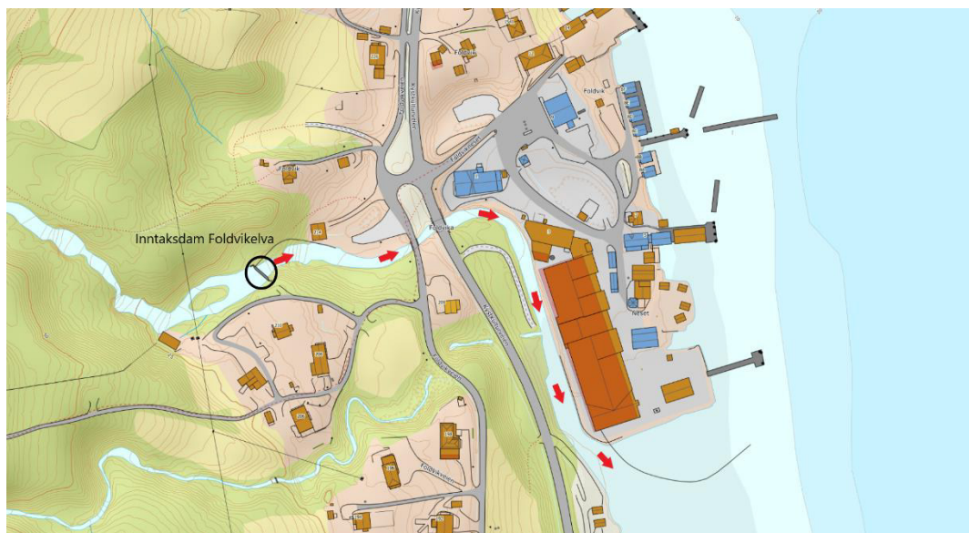
Figur 3: Oversiktskart over inntaksdam Foldvikelva og vassdraget ned til Gratangen. Røde piler viser bruddvannvei.
