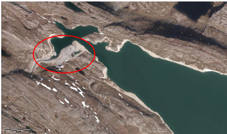
Figur 4-2. Ved nordvestspissen av Lássajávri er det tidligere etablert et tippområde i forbindelse med tunnelarbeidene. Det er vist med rød sirkel. (Kilde: Norge i bilder, 2025)
