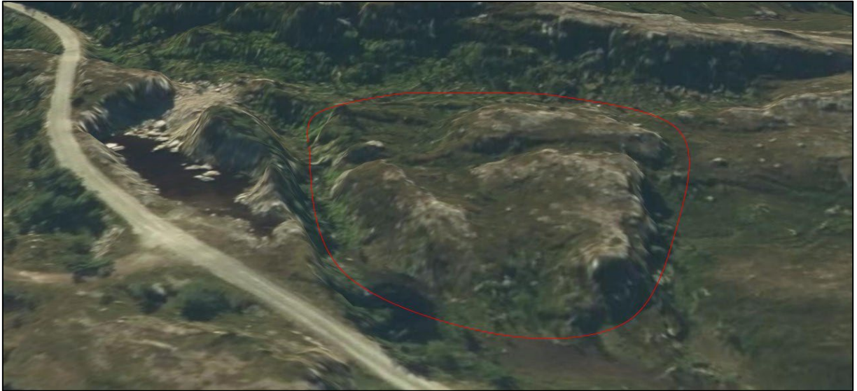
Figur 3-19. Nytt Masseuttak 1, merket med rødt. En bergrygg med skrenter og søkk på alle sider. Eksisterende Masseuttak 1 er synlig til venstre av Nytt Masseuttak 1. Illustrasjonen hentet fra ingeniørgeologisk notat. (Kilde: 3D.kommunekart.no)
